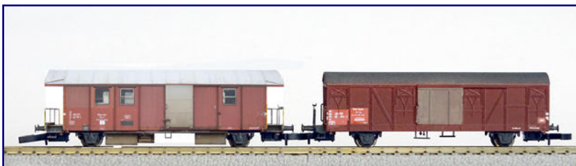
Der SBB-Bauzug (ZZ03015) enthält neben dem Materialwagen Xs auch einen komplett neuen Werkstattwagen X (links im Bild). Foto: ZettZeit, Jens Wimmel
