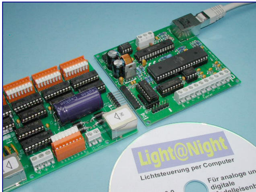
Die „Light@Night“-Steuerungen werden dank RJ45-Buchsen demnächst noch flexibler beim Einsatz auf der Anlage. Foto: Littfinski Datentechnik
