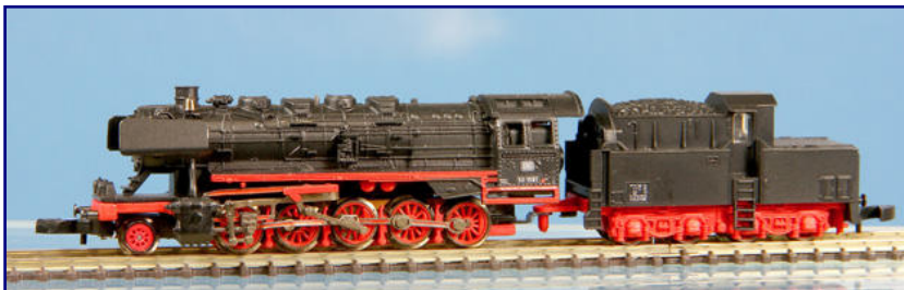
Auch der Baureihe 50 Kab (88842) stehen Detailsteuerung und Bremsennachbildungen gut zu Gesicht. Wünschenswert wären noch Bremszylinder und Indusi-Magneten unter dem Führerhaus.
