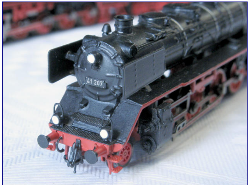
Diese Detailansicht offenbart mit den feinen Laternen samt Bügeln, Pufferbohlenzurüstung, neuen Windleitblechen, getauschter Zylindergruppe, Dampfglocke und Riffelblechen die wirkungsvollsten Umbaumaßnahmen. Foto: Dirk Rohwerder
