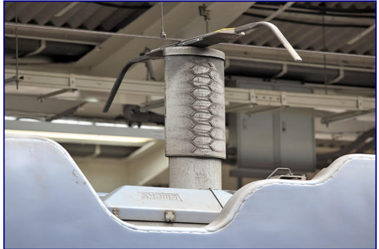
Ursprünglich trugen die Züge Stromabnehmer in der Form eines großen T. Später mussten sie Einholmpantographen weichen. Foto: Tennen-Gas (CC-BY-SA-3.0)
