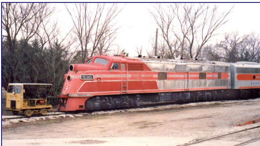
Diese Lokomotive mit der Betriebsnummer 630 der Rock Island Rock Island, eine EMD E6A des Baujahrs 1941, zeigt noch die Merkmale, wie sie bis zu den frühen Bauserien der E7 Bestand hatten: flacher geneigte Front, eckige Maschinenraumfenster und Einzellüfter. Foto: Russell Meier/CC BY-SA 3.0
