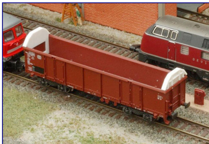
Neue Bordwände aus weißem Polystyrol für den Transport von Langholz im Eaos 106. Foto: Ratimo
