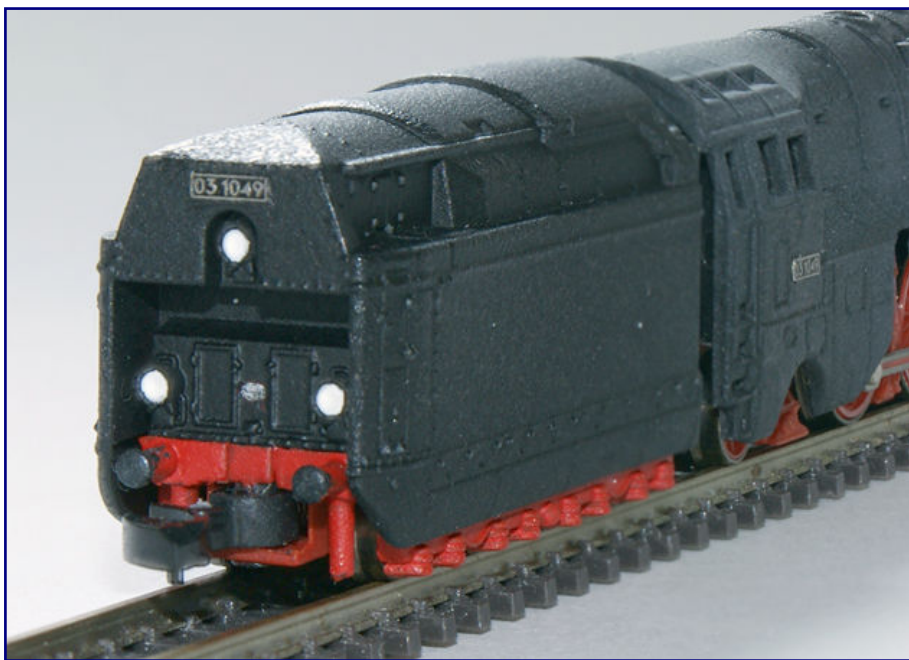
Die Modifikationen am Tender beschränkten sich auf Farbarbeiten: Die roten Teile wurden nachgearbeitet und dabei auch Pufferhülsen und Bohlenmittelstück rot und die Tenderlaternen weiß ausgelegt. Der Aufbau wurde schwarz lackiert, wobei das Fabrik Schild erhalten werden konnte.
