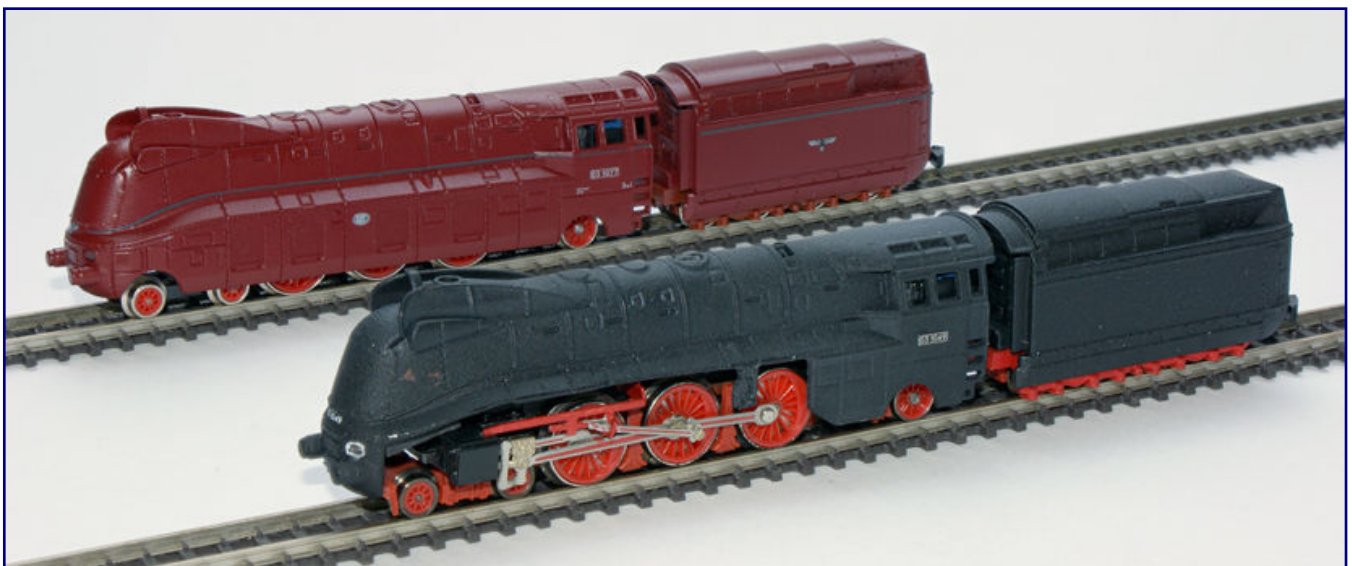
Der direkte Vergleich des Modells 88861 im Auslieferungszustand (hinten) mit der umgebauten Lok verdeutlicht den Umfang der durchgeführten Arbeiten. Doch der Eindruck der 03 1049 im Nachkriegszustand entschädigt für die Mühen.
