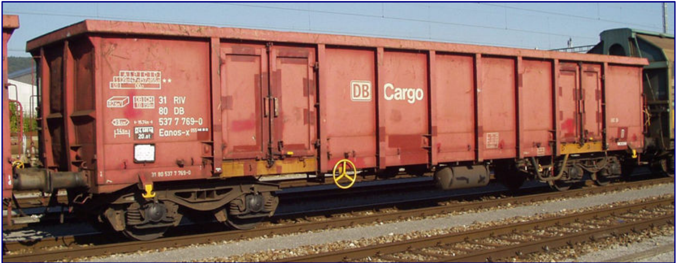
Die Gattung Eanos-x 055 bildet die Vorlage für das FR-Modell. Der hier gezeigte DB-Wagen 31 80 537 7 769-0 unterscheidet sich von ihm nur durch die Schutzbügel. Aufgenommen wurde dieser Waggon am 23. September 2005 im Rangierbahnhof Limmattal. Foto: S. Hinni (Bobo11); GNU
