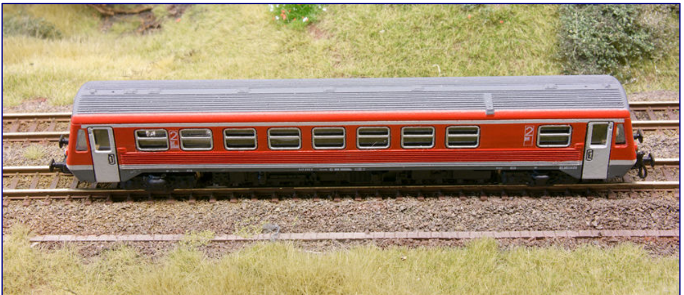
Auf dieser Aufnahme sind auch die Sicken im Dach gut zu sehen. Im vorderen rechten Bereich befindet sich an der Dachkante der Auspuff des Dieselmotors.
