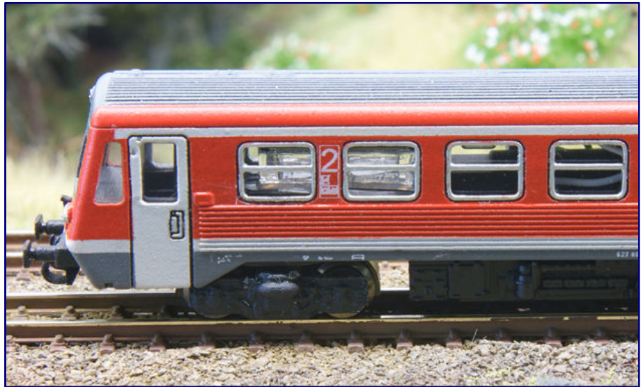
Die Konturen der Längssicken sind scharf und überzeugend, während die Drehgestellblenden weitaus weniger Details zeigen. Der Unterbau unter dem Fahrgastraum stammt vom Rokuhan-Spenderfahrwerk.
