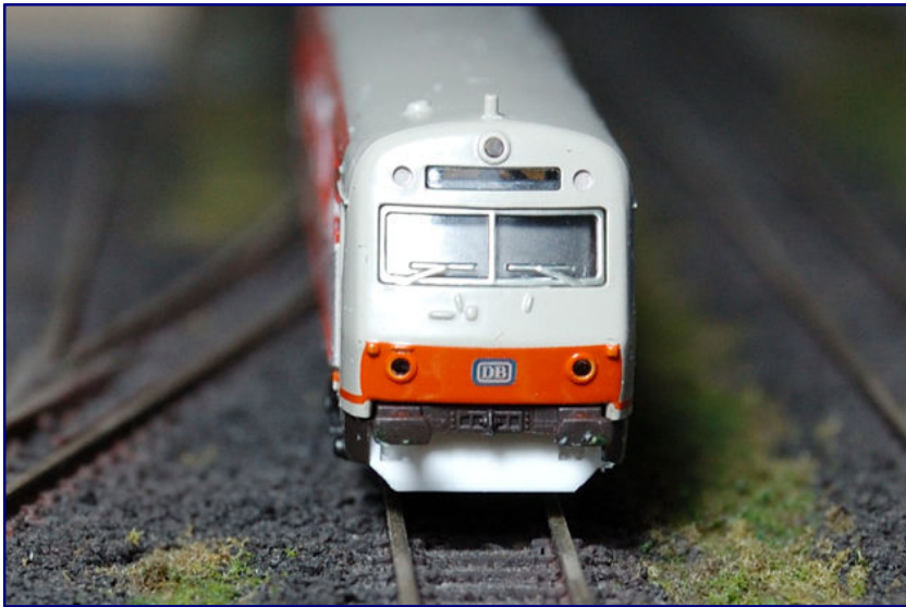
Ein kleines Details, aber doch ein gesichtsprägendes Merkmal ist die Schürze unter der Pufferbohle des S-Bahn-Steuerwagens. Hier noch unlackiert gezeigt, ist sie besonders gut zu sehen. Foto: Rainer Tielke
