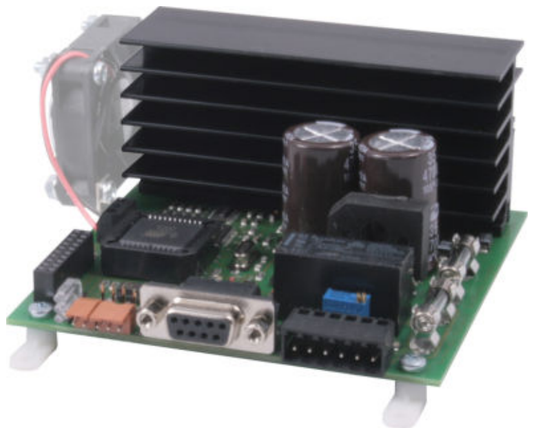
Der analoge Fahrregler SFR2000 erhält ein neues, kompaktes Bedienteil (oben). Das mit ihm verbundene Leistungsteil erlaubt in der offenen Ausführung (unten) einen Blick auf seine „Innereien“. Foto (Mitte links und unten rechts): Heißwolf Modellbahnzubehör
