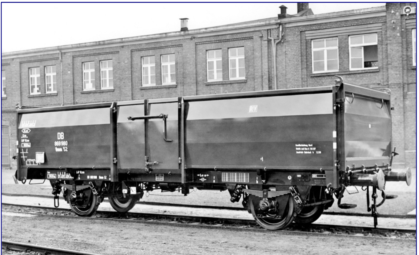
Laut seinen bereits angeschriebenen Daten dürfte diese Werksaufnahme der WAG Uerdingen des Omm 52 869 980 aus dem Januar 1956 stammen. So besitzt dieser Wagen ohne Handbremsbühne bereits die Knorr-Bremse mit Einheitswirkung. Deutlich zu sehen sind auch die Umstellhebel der Bremse links unter der Ladetür. Foto: Helmut Först, Sammlung Eisenbahnstiftung
