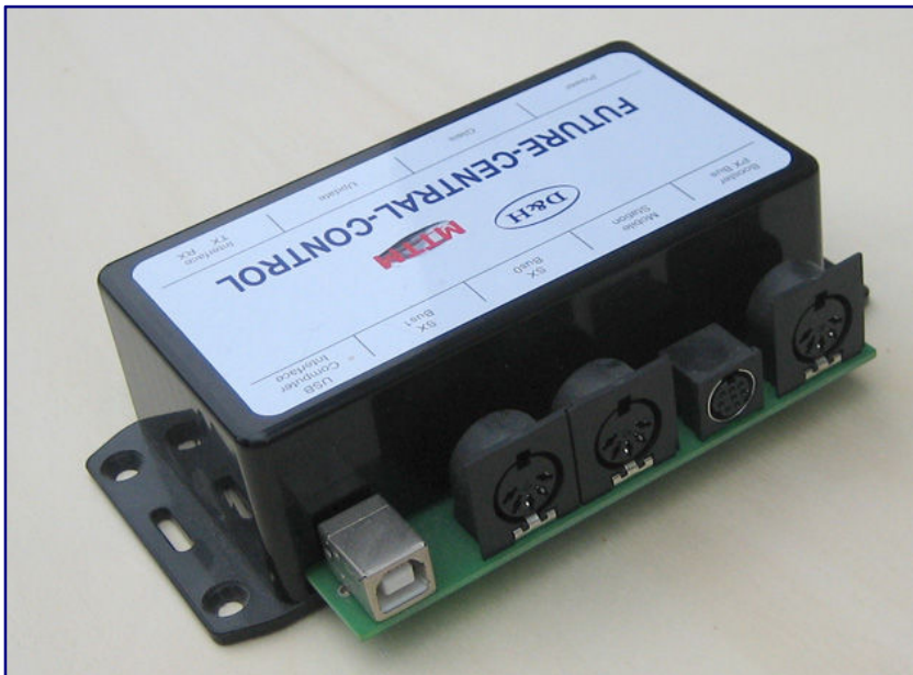
Die Anzahl der verschiedenen Schnittstellen, hier an der FCC von D&H gezeigt, sind ein wichtiges Entscheidungskriterium bei der Wahl des Digitalsystems. Foto: Andreas Hagendorf
