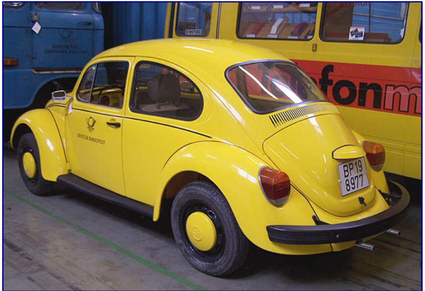
Im Einsatz stand der Käfer auch bei der Polizei, Feuerwehr oder, wie hier, bei der Deutschen Bundespost. Dieser VW 1200 zeigt hinten die „Elefantenfüße“ der letzten Käfer-Epoche. Das Fahrzeug blieb im Depot des Museums für Kommunikation, Frankfurt (Main), erhalten. Foto: Urmelbeauftragter, CC-BY-SA-3.0,2.5,2.0,1.0
