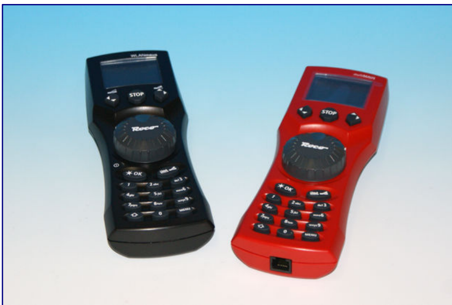
Die auch in der Spur Z eingesetzte Multimaus von Roco (rechts) ist ein Handregler und zugleich eine kleine Zentrale. Sie kann auch Weichen oder mechanische Signale schalten. Ihr moderner Nachfolger ist die WLAN-Maus (links) desselben Herstellers.
