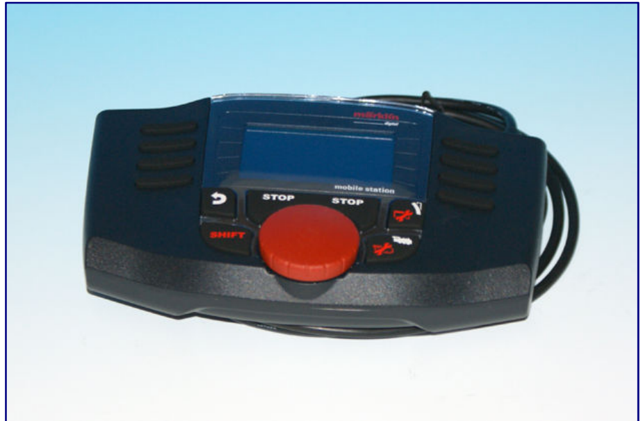
Märklin bietet alles aus einer Hand: Die Mobile Station 2 ist als kleine Zentrale auch für die Spur Z einsetzbar. Wird das sie versorgende Steckernetzteil gegen jenes des neuen Fahrreglers ausgetauscht, passt die Gleisspannung bereits.
