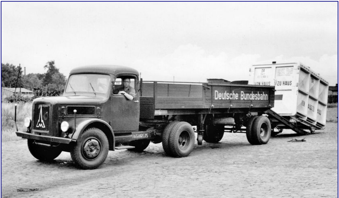
Der hier gezeigte einfache Auflieger (Deutsches Bundespatent DE814275B), der im Jahre 1951 einen geschlossenen Ekrt-Behälter (Baujahr 1950) aufnimmt, ist vom Bochumer Omnibus-, Omnibus-Anhänger- und Fahrzeugbauer von Lienen entwickelt worden und weicht von der verbreiteten Ackermann-Lösung erheblich ab. Foto: Below, Eisenbahnstiftung
