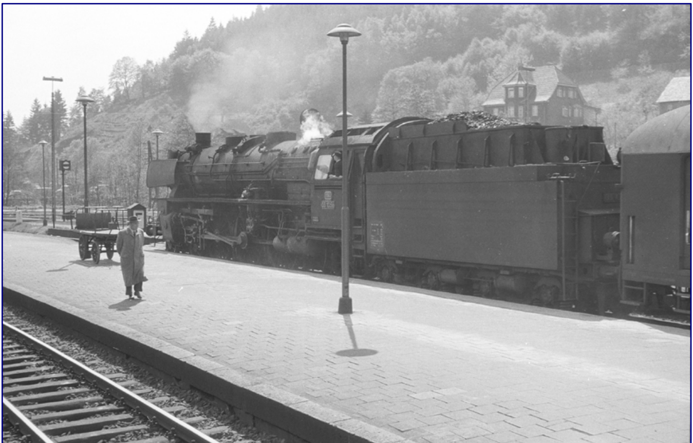
03 1056 ist hier, vermutlich in Brilon Wald, im Zustand nach ihrer Entstromung und Aufarbeitung bei Henschel im Einsatz. Noch liegt der Oberflächenvorwärmer vor dem Kamin. Auch der Tender hat bereits erste Veränderungen erfahren, wie bei genauerem Hinsehen zu erkennen ist. Zum Zeitpunkt der Aufnahme war die Lok, die als letzte einen Hochleistungskessel erhielt, wahrscheinlich bereits im Bw Paderborn beheimatet. Foto: Walter Patzke, Archiv Petkelis
