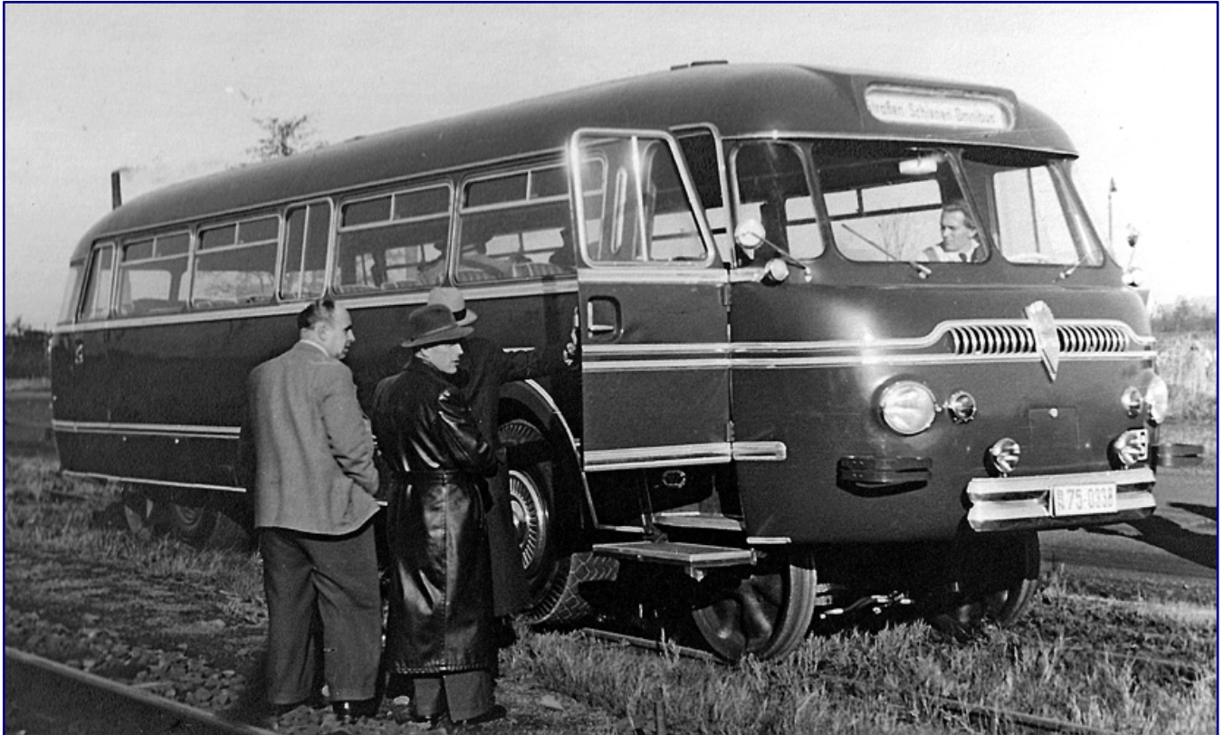
Ein historisches Dokument von heute unschätzbarem Wert schlummerte jahrzehntelang im Familienalbum: Es zeigt den Prototyp V4, Urahn aller modernen Schienen-Straße-Fahrzeuge, bei seiner Abnahme durch die Deutsche Bundesbahn Anfang 1954. Das amtliche Kennzeichen verrät, dass für dieses Einzelstück das Fahrzeug umgebaut wurde, das auch auf den Seiten 20 und 23 zu sehen ist. Foto: Archiv Kaiser
