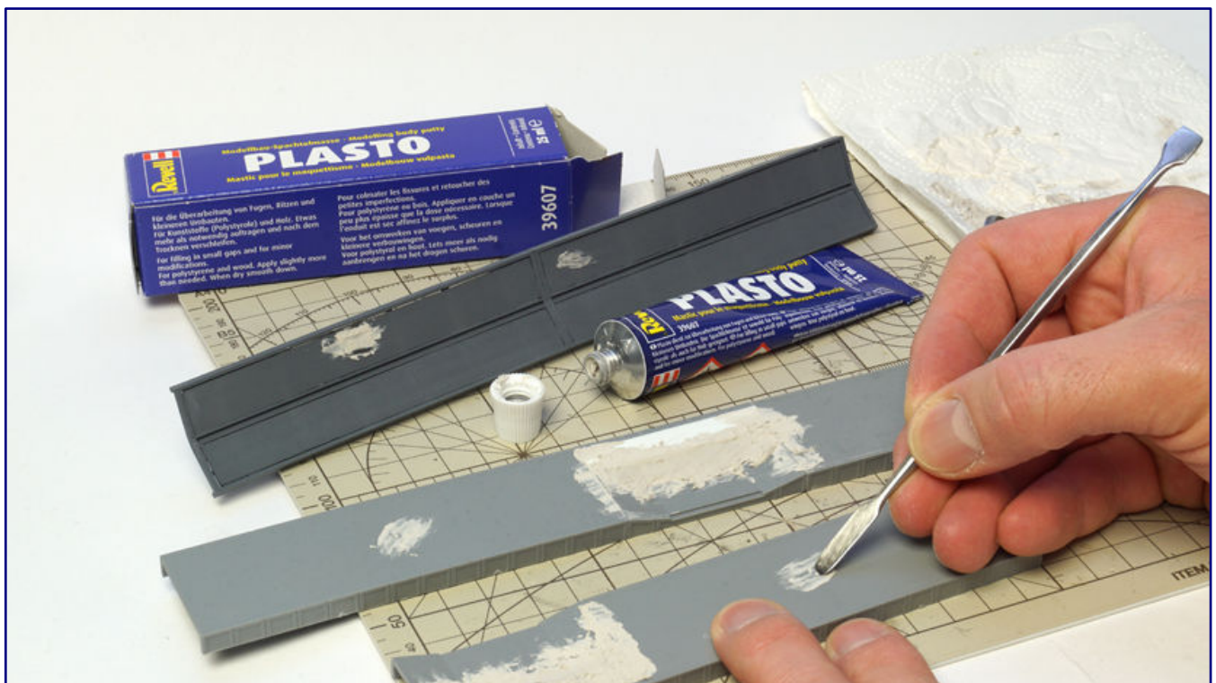
Die Feinarbeiten bestehen aus Spachteln und Schleifen, mit denen die Eigenbau-Teile dann auch zum noch folgenden Lackieren vorbereitet werden.
