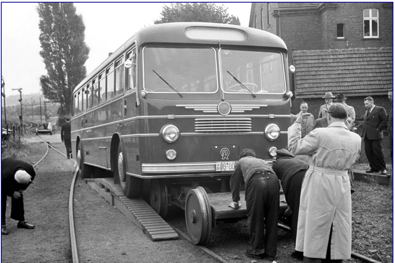
Während der Pressevorstellung am Bahnübergang Nordstraße in Ungarn Ost wurde anhand des Prototyps auch der Wechsel von der Straße auf die Spurwagen mit Hilfe einer hölzernen Rampe vorgeführt. Fotos: Willi Marotz, Eisenbahnstiftung
