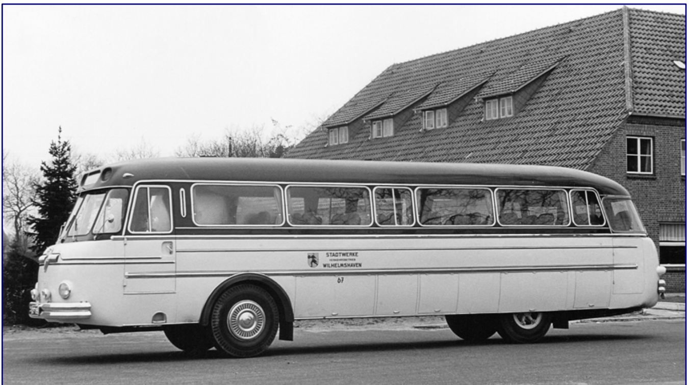
Der Schi-Stra-Bus wurde aus gewöhnlichen Straßenfahrzeugen abgeleitet. Die Straßenversion des Serienfahrzeugs war dieser ebenfalls von einem KHD-Motor angetriebene NWF BS 300. Das Exemplar mit Wilhemshavener Besatzungskennzeichen war für die örtlichen Stadtwerke bestimmt. Foto: Werksaufnahme NWF, Archiv Bernd Coldewey
