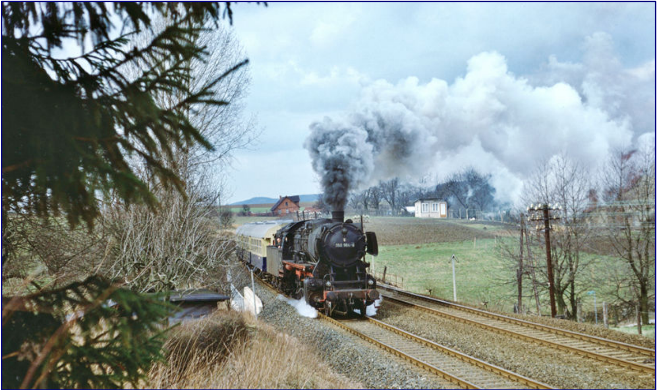
Eine typische Bespannung für die seit 1967 im Einsatz stehende Garnitur aus dreiachsigen Umbauwagen war die Baureihe 50. Noch am 27. März 1976 kam die 050 964-6 des Bw Lehrte mit dem Sonderzug bei Harriehausen zum Einsatz. Foto: Dr. Uwe Knoblauch, Eisenbahnstiftung
