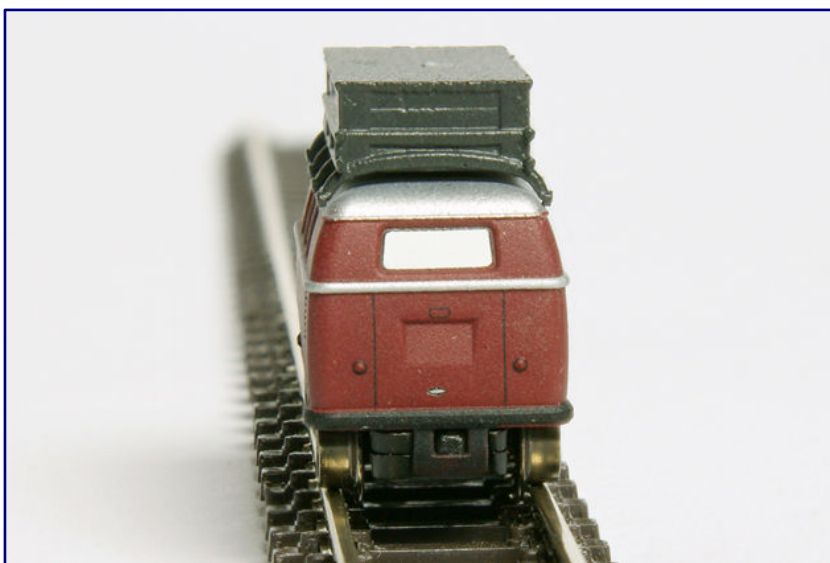
Auch die Rückseite präsentiert sich mit vielen per Tampondruck hervorgehobenen Details und gravierten Rückleuchten. Doch statt diesen müsste eigentlich im rechten Heckbereich eine einzelne, rote Schlussleuchte zu finden sein.
