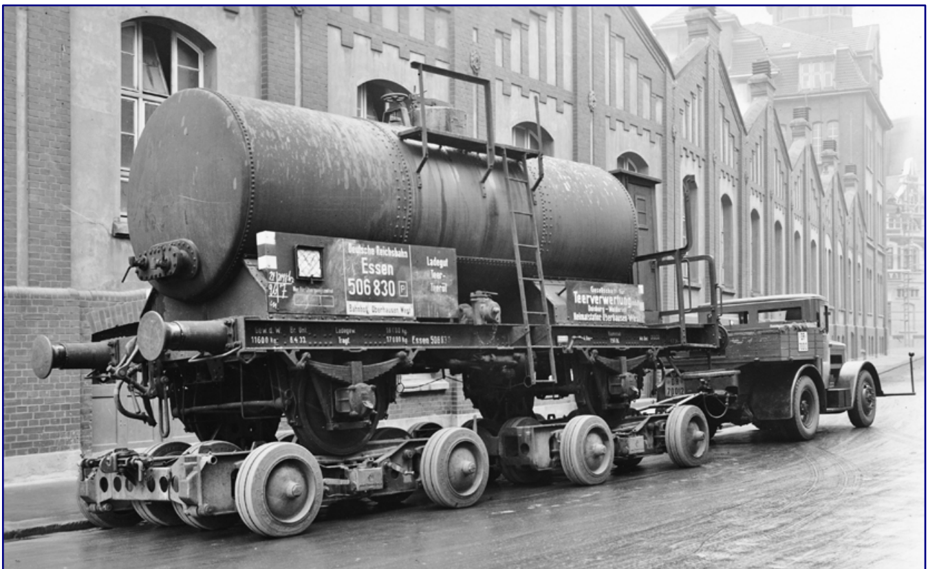
Dieser zweiteilige Straßenroller und die 65 PS starke Standard-Zugmaschine Kaelble Z 4 GR waren Vorlage für die Märklin-Modelle. Aufgenommen wurde der Kesselwagen 1934 auf Zustellfahrt nach Viersen, geladen hatte er Teeröl. Dieses Spaltprodukt aus den Kokereien des Ruhrgebiets wurde zum Herstellen von Asphalt oder Bitumen verwendet. Foto: RVM, Archiv Eisenbahnstiftung
