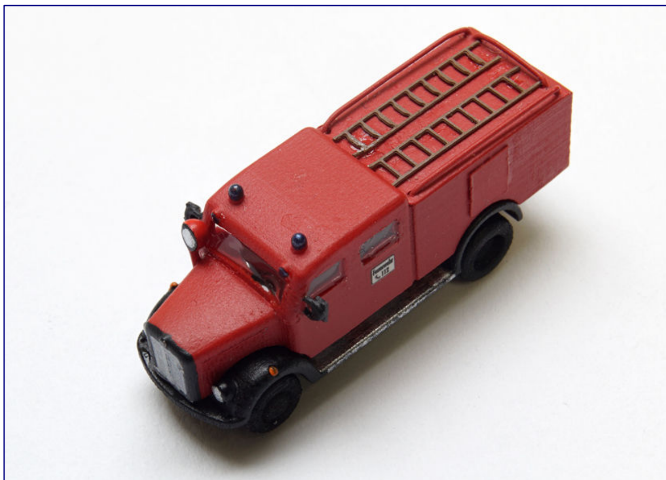
Passende Artitec-Leitern wurden ausgewählt, gekürzt und neu in einem matten, holzähnlichen Erdton lackiert (Bild oben). Nach dem Trocknen konnten sie auf dem Dach verklebt werden und die drei Fahrzeugteile dauerhaft zusammengefügt werden (Bild unten).
