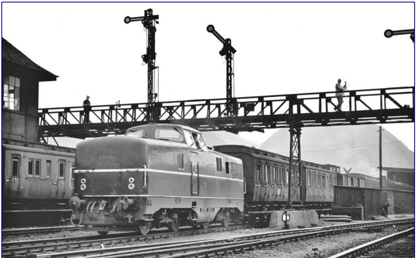
V 80 004 vom Bw Frankfurt-Griesheim schiebt 1954 ihren Personenzug aus Donnerbüchsen zwischen Abzweig Galluswarte und Frankfurt-West zweifelsfrei unter indirekter Wendezugsteuerung, wie an der Blickrichtung des auf der Lok verbliebenen Lokführers zu sehen ist (Bild oben). Dieselbe Lok musste im Oktober 1952 noch mit preußischen Abteilwagen Vorlieb nehmen, als sie den Frankfurter Hauptbahnhof verließ (Bild unten). Das Dreilichtspitzensignal war damals noch nicht vorgeschrieben. Fotos: Reinhold Palm, Eisenbahnstiftung
