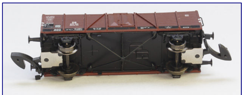
Blick auf den Wagenboden aus geätzten Metallblechen mit dem räumlichen Sprengwerk.
