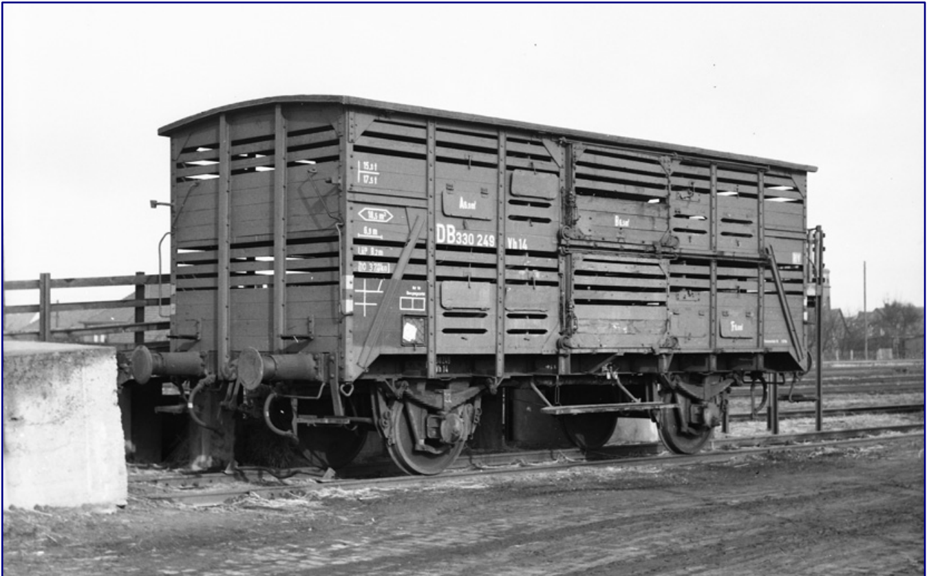
Die ab 1913 in einer Gesamtstückzahl von 2.133 Exemplaren gebauten Verschlagwagen der Verbandsbauart A8, bei der DB als Vh 14 bezeichnet, waren der direkte Vorgänger des späteren V 23. Abgelichtet wurde dieses Exemplar im April 1958 im Bahnhof Uchte. Foto: Reinhard Todt, Eisenbahnstiftung
