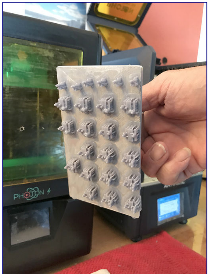
Der Druck ist abgeschlossen (Bild links), die Modelle zeigen sich nach der Entnahme an der Druckplatte (Bild rechts) und warten auf das weitere Bearbeiten.
