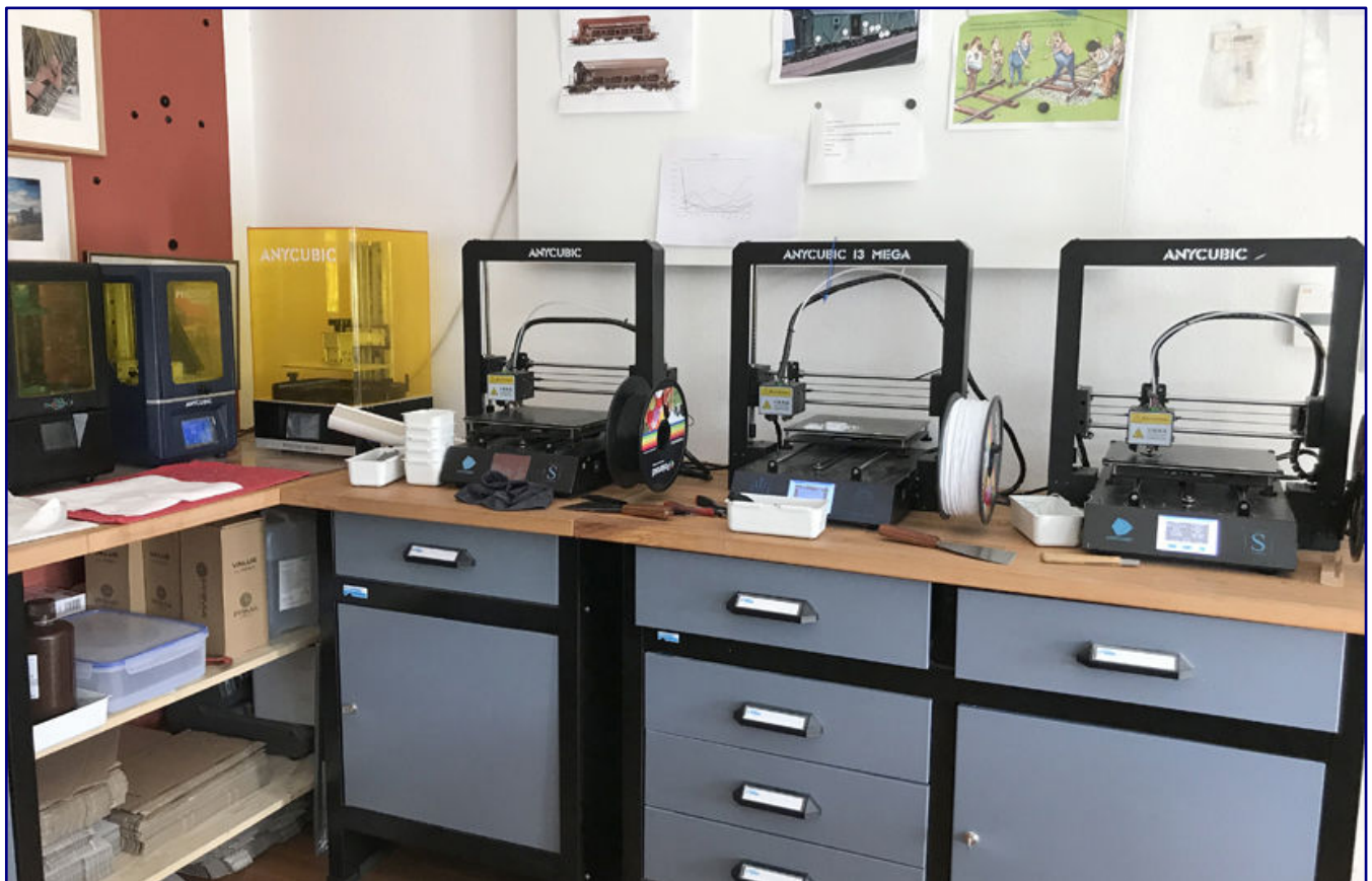
Ein Blick auf die sechs 3D-Drucker, die heute für NoBa-Modelle arbeiten: Gedruckt wird je nach Anforderung ans Ergebnis im PLA- und SLA-Verfahren.
