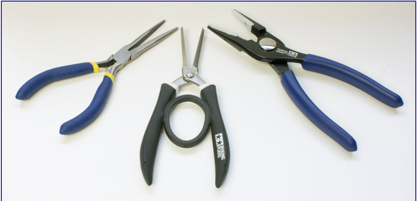
Die Mini-Spitzzange von Revell (Art.-Nr. 39079; links), die Formzange für Fotoätzteile (300074067; Mitte) und die Spitzzange mit Verkratzschutz (300074065; rechts), letztgenannten beiden von Tamiya, stellen wir kur als wertvolle Werkzeuge für den Modellbau vor.
