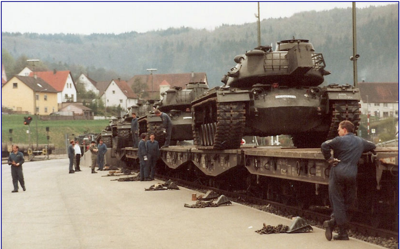
1988 werden in Stetten am kalten Markt Kampfpanzer des Typs M48 der Bundeswehr verladen. Erahnen lässt sich die Präzision, mit der die überbreiten Fahrzeuge auf die Schwerlastwagen zu bewegen sind. An der Rückseite des Turms ist fast mittig der Scheinwerferkasten zu sehen, der beim Leopard 1A1 (Märklin-Modell) auf der Vorderseite sitzt. Foto: Christian Liebau
