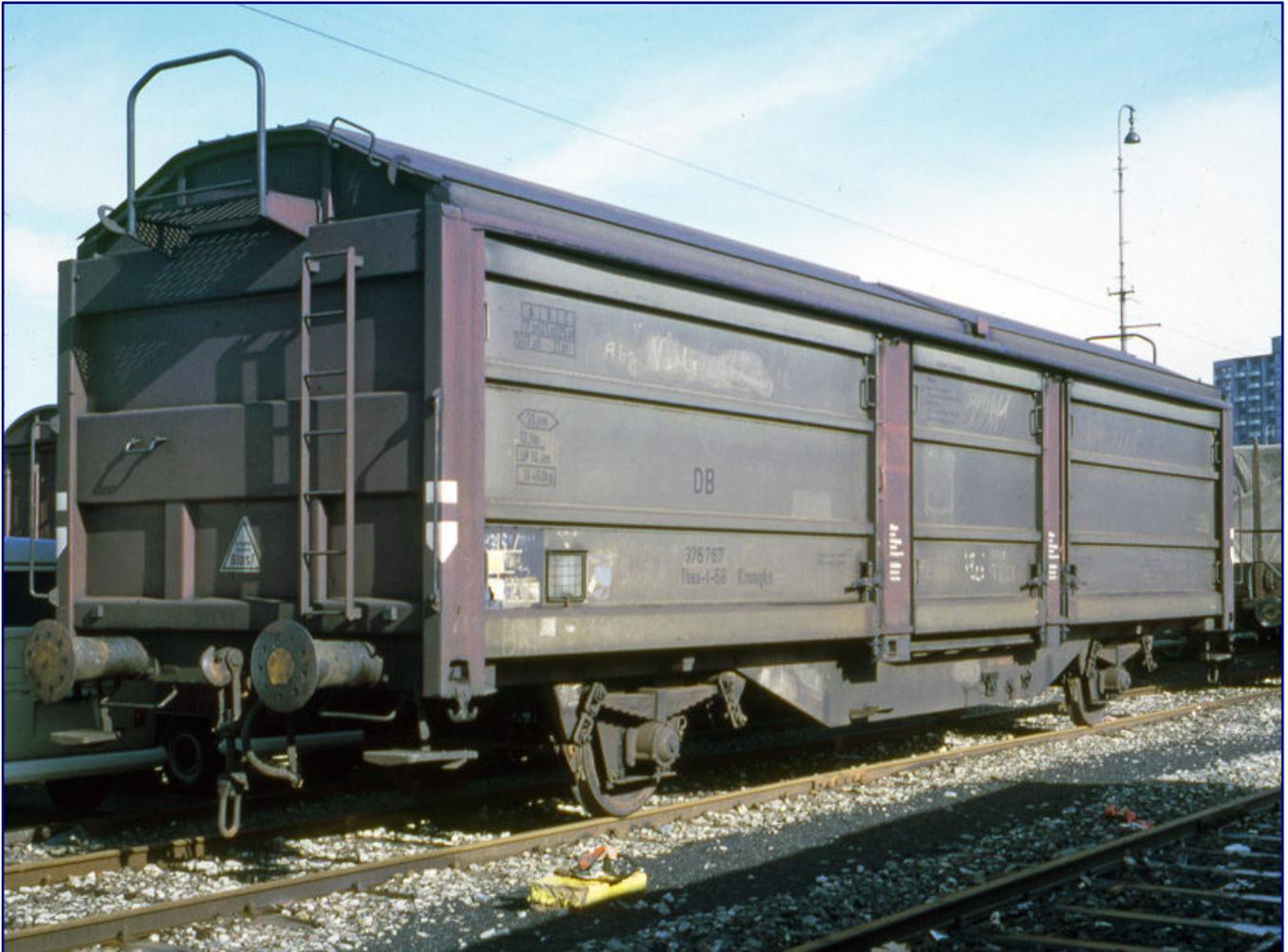
Der in Stuttgart Hgbf abgelichtete Tbes-t-68 / Klmmgks 376 767 entspricht in seiner Ausführung den beiden Märklin-Modellen aus der Packung 82153. Daher erlaubt er einen Vergleich (siehe auch Foto auf Seite 4) zu einigen Details: Seine Aufstiegsleiter ist rotbraun (nicht schwarz) lackiert und auch das in Wagenkastenfarbe (statt Dachfarbe bei den Modellen) lackierte Querportal ist auszumachen. Foto: Fritz Willke, © Stefan Carstens
