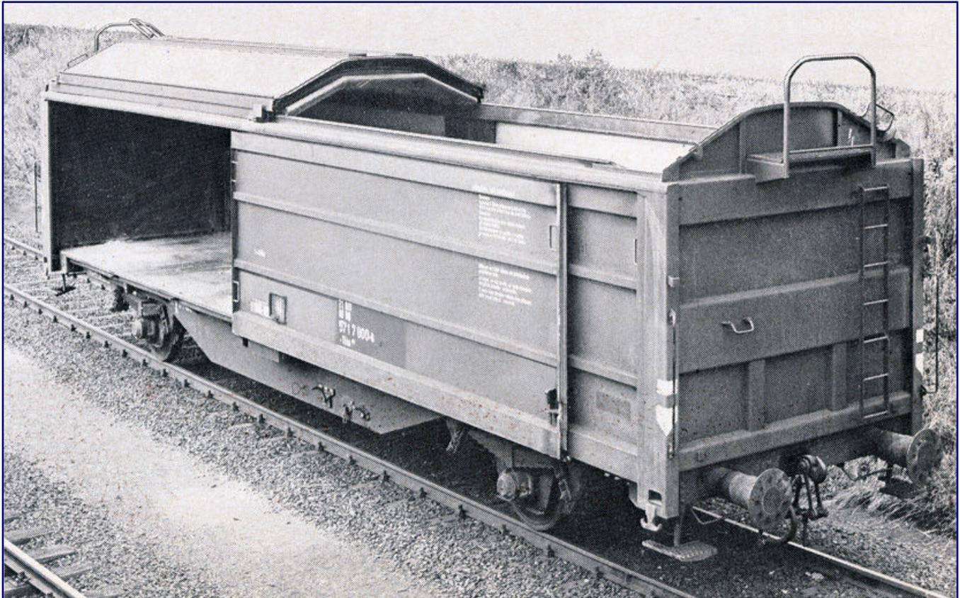
Mit dieser Aufnahme eines Tbis 870 demonstrierte die DB ihren Kunden die hohe Flexibilität beim Be- und Entladen der Wagen. Die halbe Dachfläche und bei dieser Bauart auch die halbe Seitenwand waren zeitgleich zugänglich. Auf dem Foto zu sehen sind auch das Querportal zum Versteifen des Aufbaus und am Dachende die Fanghaken für das Schiebedach. Foto: Werbeamte der Deutschen Bundesbahn, Sammlung Trainini
