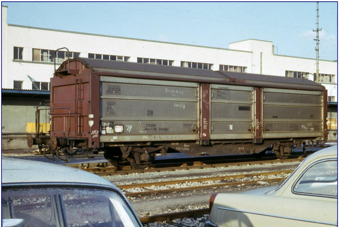
Perfekt abgelichtet ist der Tbes-t-68 / Klmmgk der Bundesbahn mit der Betriebsnummer 376 689. Dieser Waggon gehört zu den Exemplaren mit Handbremse und ist 500 mm länger als Märklins direkte Vorlage. Einem Abgleich gegen das Modell steht trotzdem nichts im Wege. Foto: Fritz Willke, © Stefan Carstens
