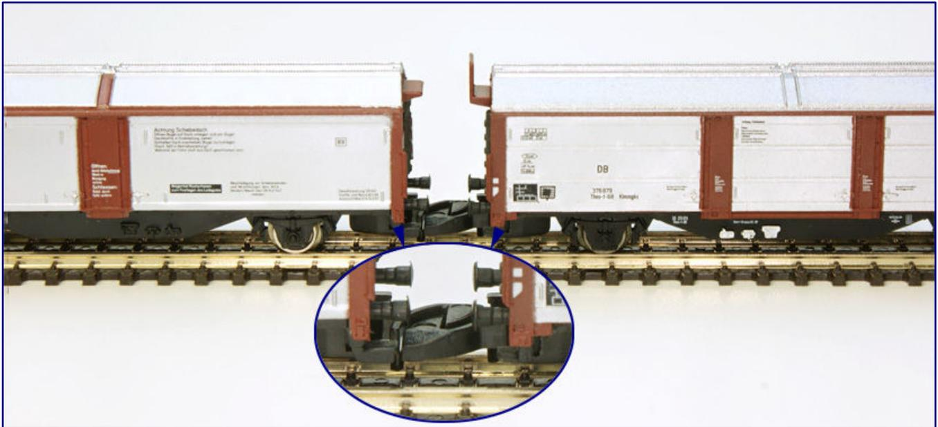
Während die gedruckten Anschriften kleiner und feiner als 1981 wiedergegeben wurden, liegen die Gravuren der Neuheiten (82153; rechts) überwiegend gleichauf mit dem alten Waggon (8623; links). Einzelne Merkmale wie die UIC-Seilanker an den Eckstreben (Ausschnittsvergrößerung) waren einst aber besser herausgearbeitet und leichter zu erkennen.
