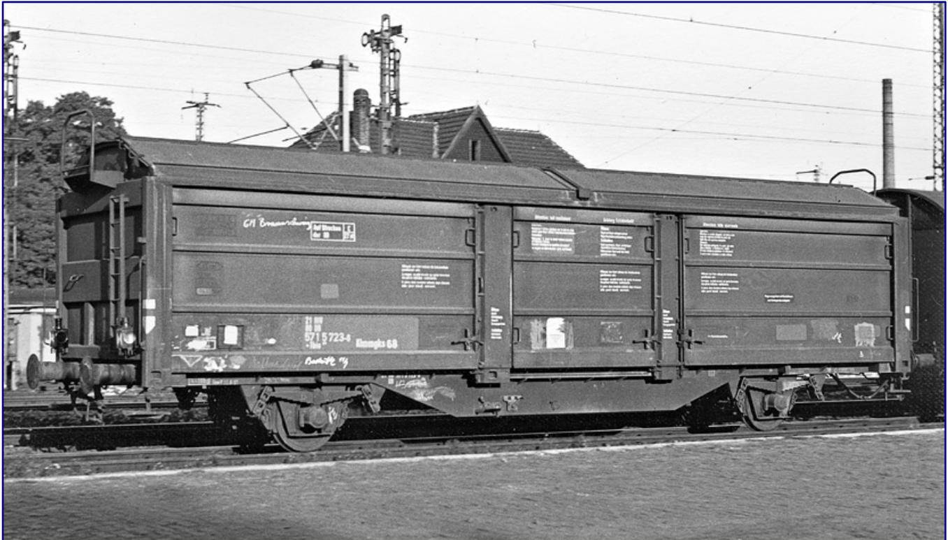
Der Tbis 871 mit der Betriebsnummer 21 80 571 5 723-0 zeigt in Bebra einen verschmutzten Zustand mit ersten Ausbesserungsflecken. Interessant ist, dass er immer noch seine alte Bauartbezeichnung Klmmgks 68 mitangeschrieben trägt. Im Abgleich gegen die Aufnahme auf Seite 6 werden auch die konstruktiven Änderungen an den Schiebetüren deutlich. Foto: Joachim Claus, Archiv Eisenbahnstiftung
