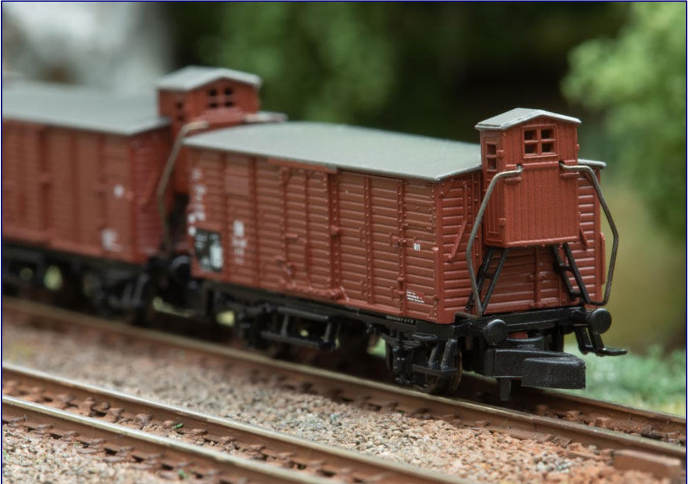
Das bis zur Dachkante rückgebaute Bremserhaus, gern auch als „Sparbremserhaus“ bezeichnet, ist ein neu konstruiertes Ansetzteil, mit dem die fünfteilige G-10-Güterwagenpackung (86605) ihre Kunden ansprechen soll. Foto: Märklin
