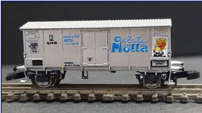
Drei verschiedene Ausführungen von Kühlwagen des Typs Hg der FS sollen auch die Bauartunterschiede demonstrieren: kurzer Achsstand ohne (Bild oben) und mit Bremserhaus (Bild Mitte) sowie einer der bekannten Vertreter mit weit außenliegenden Achsen (Bild unten). Fotos: ZetNa 220
