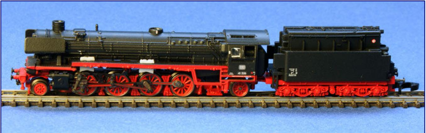
Tiefliegende Sandkästen, wie sie die Baureihe 042 nach ihrer Neubekesselung von Anfang an besaß, bietet NoBa-Modelle demnächst zur Eigenmontage in korrekter Anzahl und Platzierung als Zurüstsatz an. Die in Resin 3D-gedruckten Sandkästen bestehen jeweils aus einem Unter- und Oberteil, die am Umlauf möglichst in Bohrungen eingeklebt und noch schwarz lackiert werden. Für diese Aufnahme sind sie zur besseren Darstellung noch unlackiert zu sehen.
