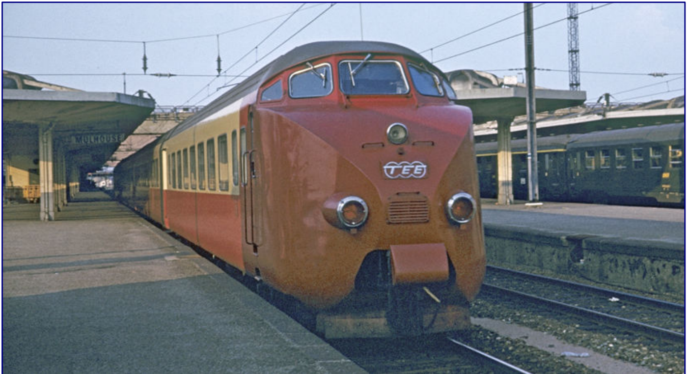
Die auf Seite 5 abgebildete Garnitur erlaubt nach dem halt auch einen Blick auf den Steuerwagen, der neben einem Großraumbereich auch einen Ruheraum für den Bordmechaniker beherbergte. Foto: Joachim Lutz (CC-BY-SA-4.0)
