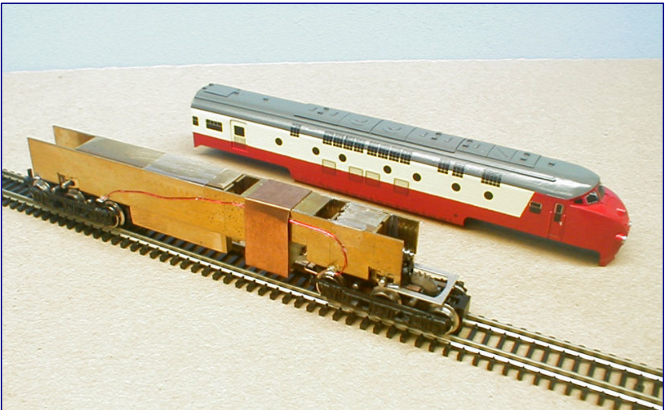
Fahrwerkskonstruktion und Stromversorgung des Märklin-Dreipolmotors sind hier aus zwei verschiedenen Perspektiven zu sehen. Der prinzipielle Aufbau folgt dem zuvor gebauten ALn 442 / 448 der FS.
