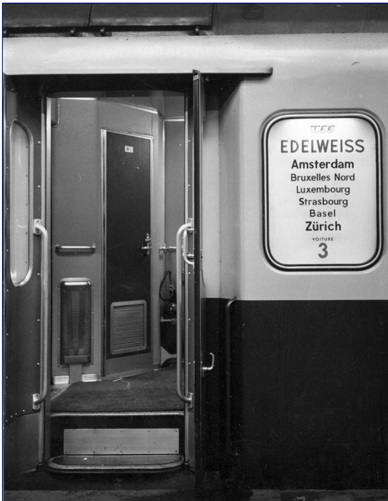
Blick auf den Einstieg eines Wagens im November 1969: Zu sehen sind das in einem Fenster untergebrachte, beleuchtete Zugzielschild, der außermittig angeordneten Übergang zum Nachbarwagen und auch, dass die gegenüberliegende Einstiegstür versetzt angeordnet sein muss. Foto: Nederlandse Spoorwegen / Het Utrechts Archief; Katalognr. 153476 (CC0 1.0)
