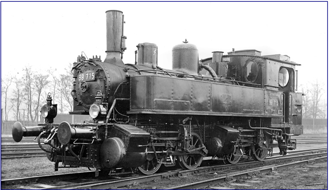
Zum 13. BDEF-Verbandstag in Zwiesel (7. bis 10. Mai 1970) wird auch Werklok 4 „Zuckersusi der Südzucker AG (ex 98 727; Bild oben), Regensburg, ausgestellt. Sie zeigt den eckigen Sandkasten, den sie noch bei der DRG im Rahmen eines Umbaus erhalten hatte. 1938 zeigt sich die frisch ausgebesserte 98 715 noch mit rundem Sandkasten im RAW Weiden (Bild unten). Fotos: Helmut Röth (Bild oben) und DLA Darmstadt (Maey), beide Sammlung Eisenbahnstiftung
