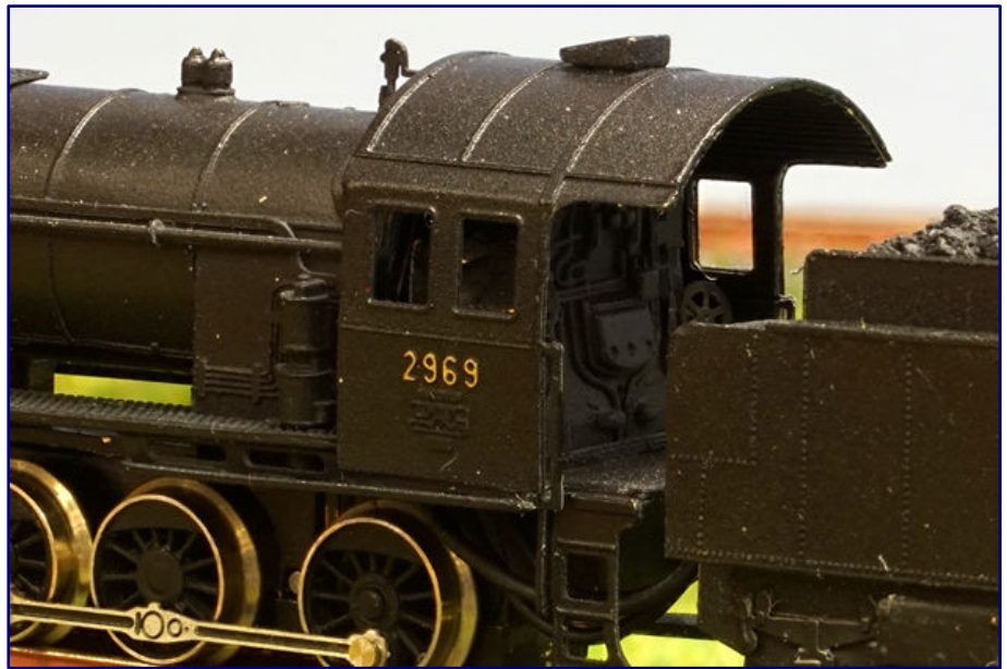
Diese Aufnahme zeigt nicht nur den unterschiedlichen Kuppelachsstand anhand des dritten, vierten und fünften Kuppelrads, sondern vor allem den Führerstand mit Inneneinrichtung!
