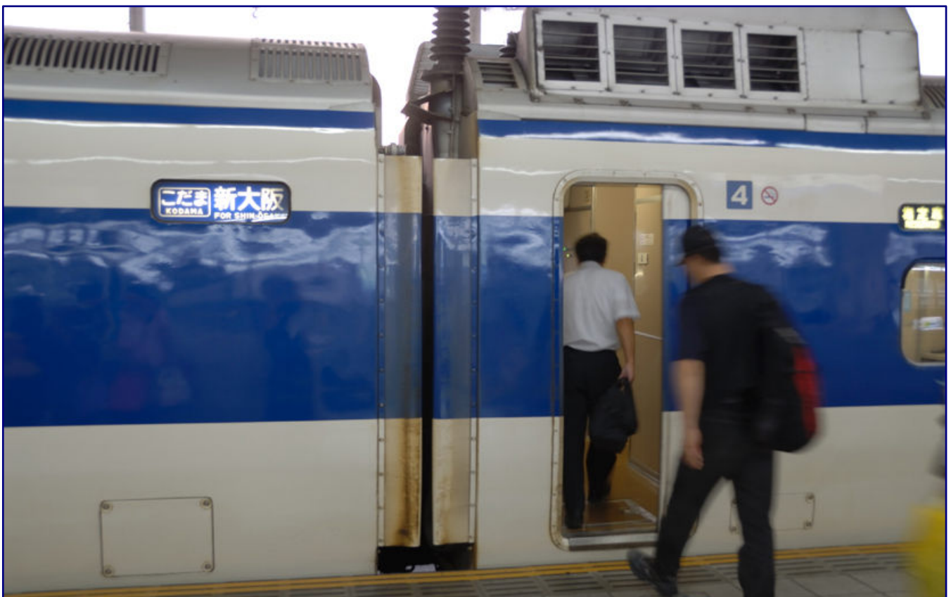
Aufnahmen von Stirn und Wagenübergang mit Windleitblech in den letzten Betriebsjahren. Fotos: Cassiopeia sweet (PD-self; oben) / Takeshi Kuboki from Amagasaki, Japan (CC-BY-2.0; unten)
