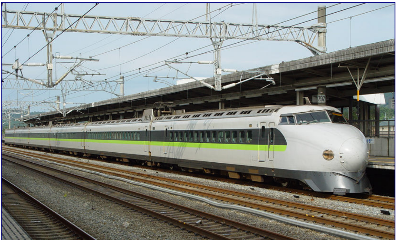
Als Kodama 635 ist diese sechsteilige Einheit in neuen, sehr ansprechenden Farben unterwegs, als sie in Higashi-Hiroshima auf der San'yō -Linie dem Fotografen vor die Linse fährt. Der Zuglauf führt von Shin-Osaka nach Hakata. Der Zug zeigt Windleitbleche neben dem Stromabnehmer und die im Text beschriebenen, kleineren Seitenfenster, die zum Einsparen von Kosten zeitweilig eingebaut wurden. Foto: © DAJF / Wikimedia Commons / CC BY-SA 3.0 & GFDL
