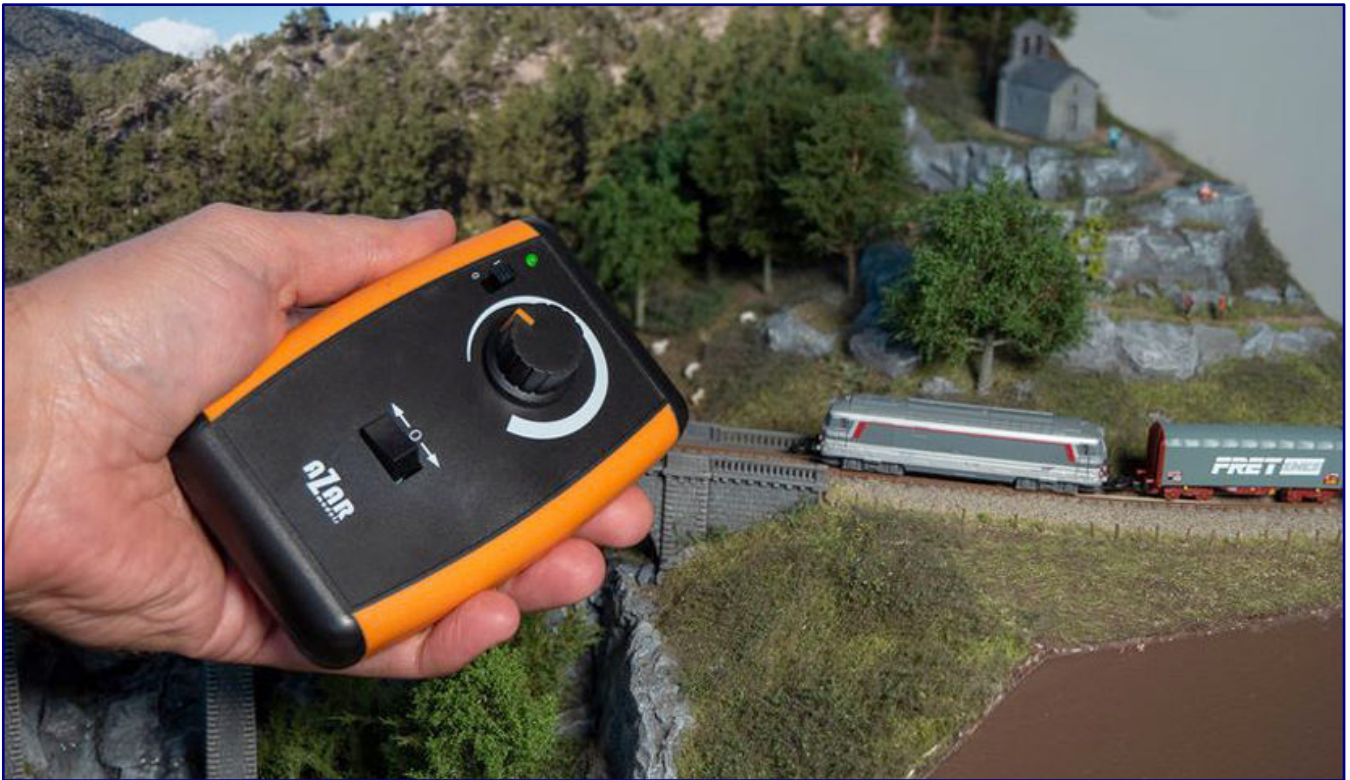
Mit dem Zmaster ist nun ein neuer PWM-Fahrregler aus Frankreich für die Spurweite Z auf den Markt gekommen. Foto: Azar Models
