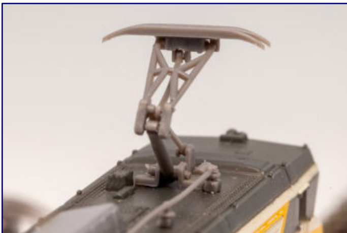
Die neuen Einholm-Stromabnehmer aus Kunststoff berücksichtigen viele Details. Foto: Azar Models
