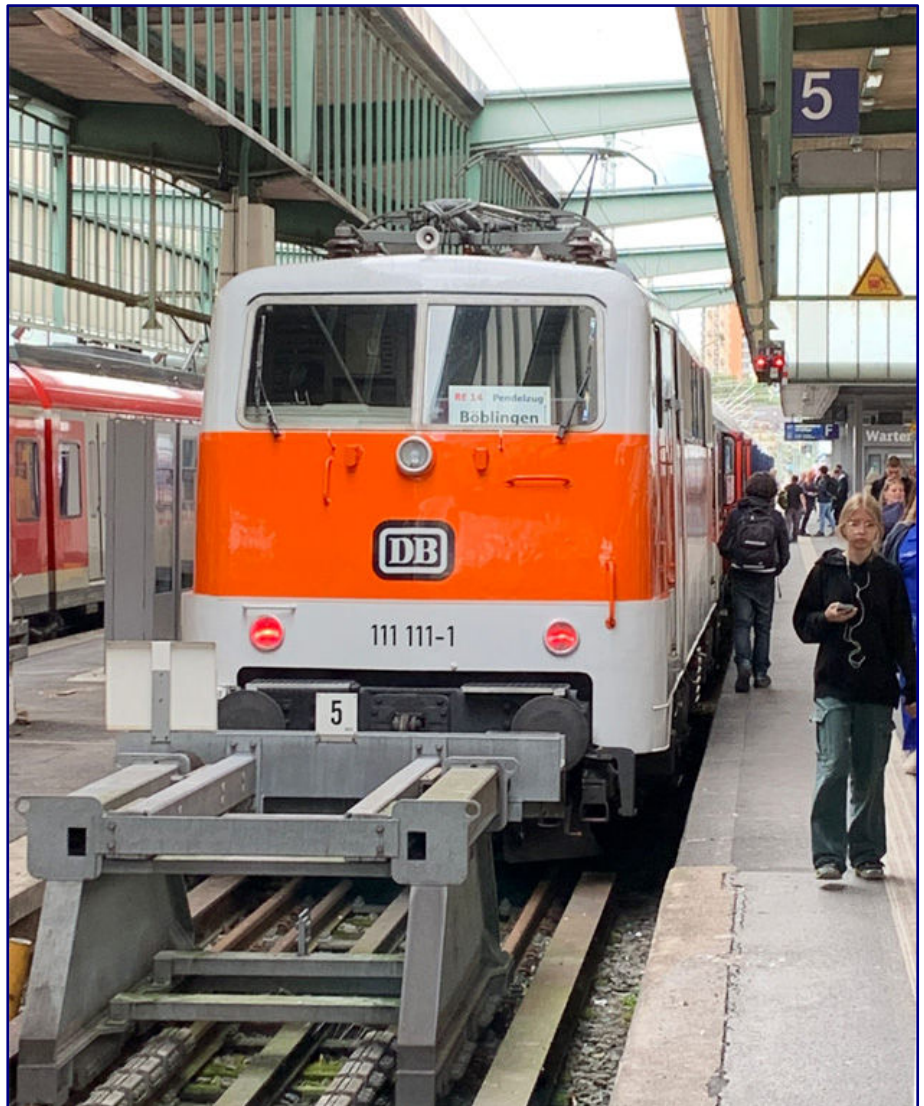
Betrachten wir 111 111-1 bei ihrer Wende am 7. August 2023 in Stuttgart Hbf, so nehmen wir den dünnen Fahrdrabt über ihr kaum wahr. Aber auch der Einholmstromabnehmer vermittelt einen deutlich anderen Eindruck als die Umsetzungen von Märklin. Foto: Alexander Hock
