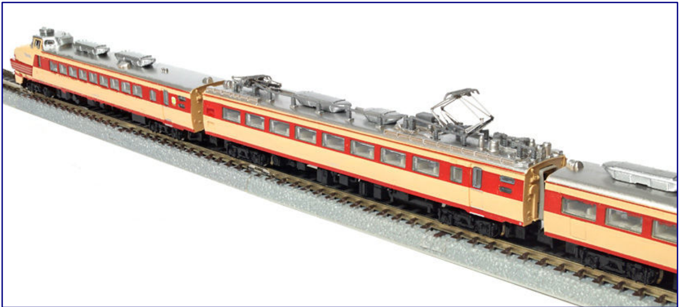
Gelungen wirken die Scherenstromabnehmer auf den Dächern des Elektrotriebzugs Serie 485 der JNR von Rokuhan: filigran, größenrichtig, korrekt gelagert und mit Diagonalstreben versehen. Der vordere, abgelegte Stromabnehmer liegt zudem flach auf.
