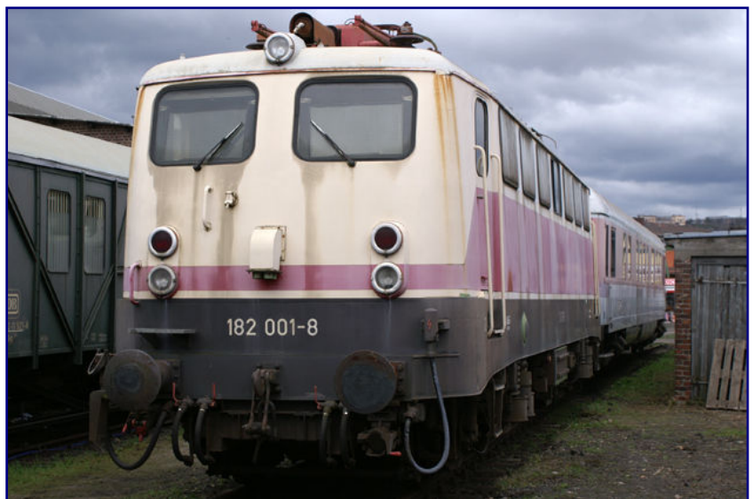
Hinter dem AEG-Versuchsträger 182 001-8 für die Drehstromtechnik verbirgt sich die ehemalige E 320 001 – eine der Zweisystemlokomotiven erster Generation.
