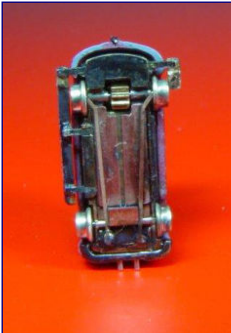
Angetrieben ist nur die Vorderachse, zu der auch Bronzeradschleifer führen. Die Räder sind aus Rundmessing gefertigt.
