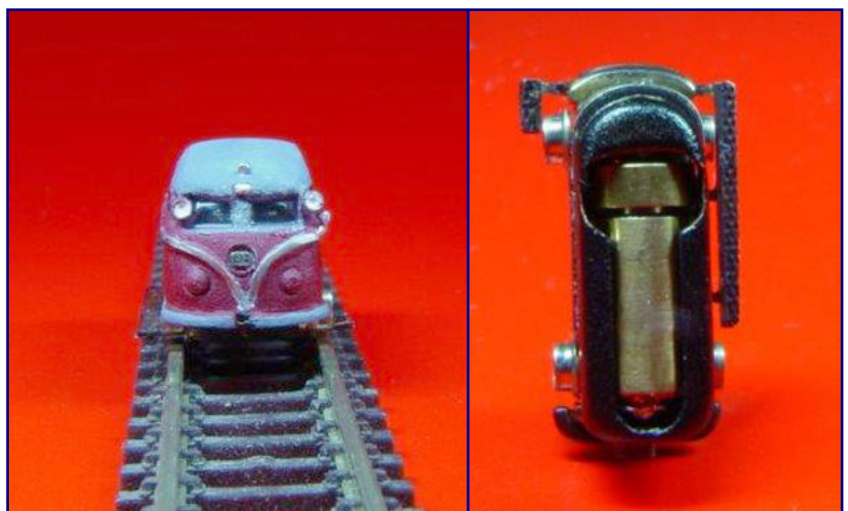
Viele, winzige Details folgten noch an der Karosserie der Draisine (linker Bildteil). Für das Fahrwerk waren noch Tritte zu fertigen und daran anzubringen (rechts).
