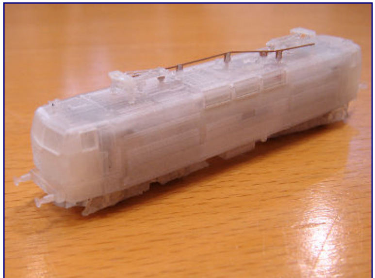
Mit diesem per Stereolithographie hergestellten Handmuster überraschte uns Rokuhan auf der Spielwarenmesse im Januar. Schon da war klar: Hier kommt es etwas ganz Besonders auf die Zetties zu!
