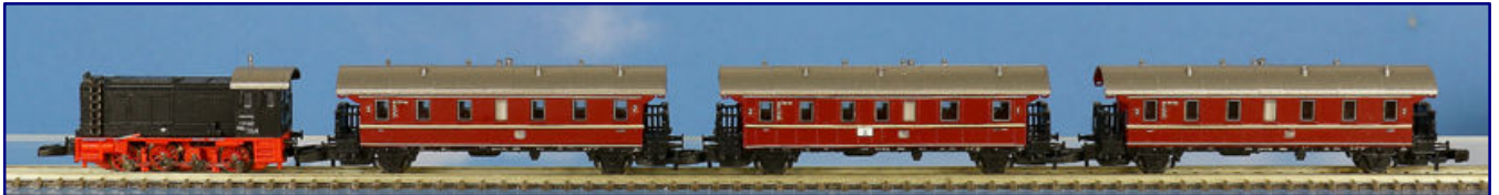
Eine ansprechende Zusammenstellung ist die V 36 237 als frühe DB-Lokomotive mit drei Donnerbüchsen in Triebwagenlackierung (81770). Die Lokomotive erhält laut Hersteller vorbildgerecht noch eine Glocke auf dem Vorbau.
