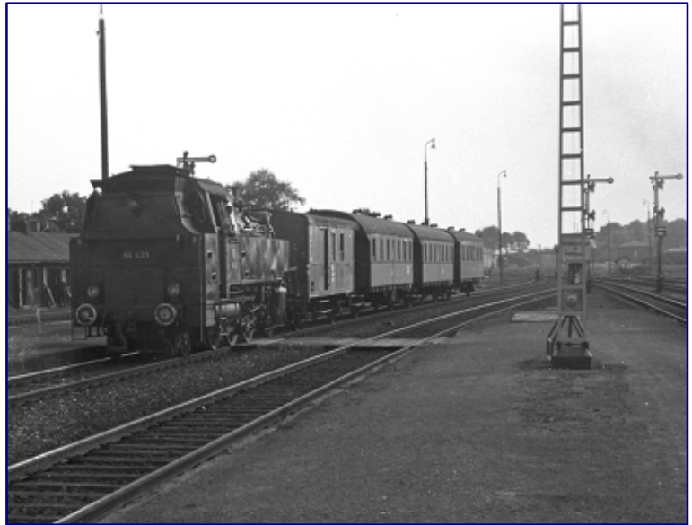
Auch rund um die Schiefe Ebene waren Bubiköpfe unterwegs, wie 64 421 im August 1962 in Marktredwitz beweist. Am Haken hat sie eine Garnitur Donnerbüchsen und einen Güterzuggepäckwagen Pwghs 41. Foto: Walter Patzke, Archiv Petkelis
