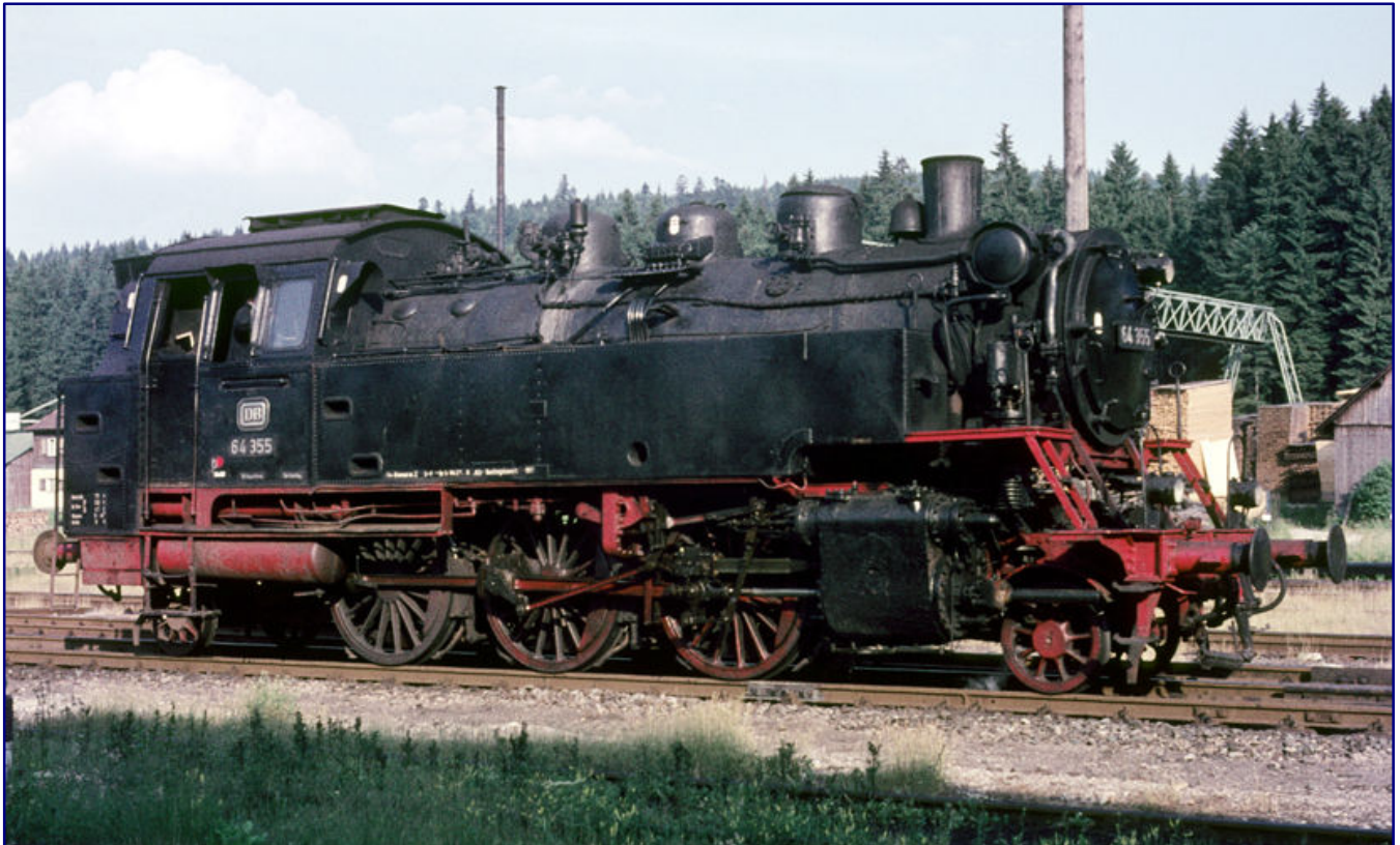
Auch 64 355 zeigt 1965 in Bayerisch Eisenstein das typische Aussehen einer DB-Maschine ihrer Baureihe: zweistufige Luftpumpe, Reflexglaslampen, rote Leitern sowie Rauchkammerträger und den roten Punkt am Führerhaus zur Kennzeichnung der Stahlfeuerbüchse. Deutlich ist am Reglerdom die Dampfeife zu sehen, die dem Märklin-Modell fehlt. Foto: Archiv Petkelis
