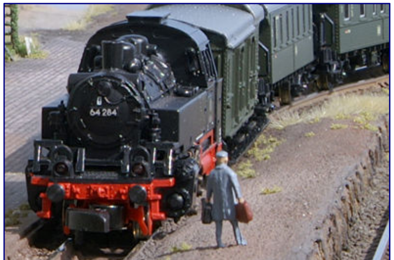
Die weit herausragenden Zylinder des Bubikopfes führen zu einer gravierenden Abweichung des Modells von den Vorbildmaßen.
