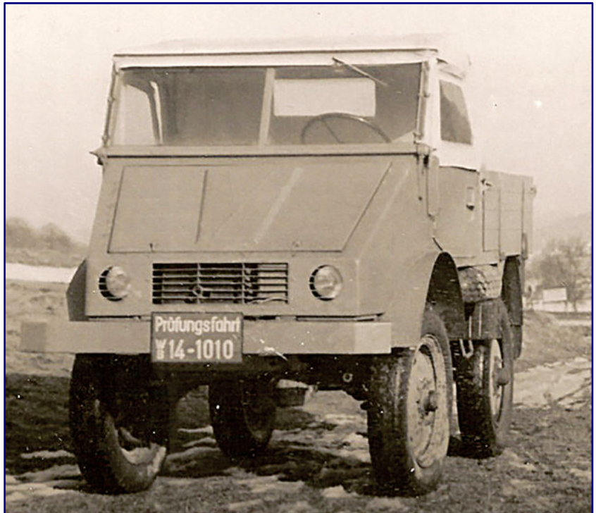
Die Geburtsstunde des Unimog datiert auf den 9. Oktober 1946, als die erste „Prüffahrt“ mit einem noch nicht ganz fertigen Prototyp erfolgte. Hier sehen wir einen ersten fahrfertigen Prototyp mit Dieselmotor OM 636 und LKW-Bereifung im Dezember 1946 bei einer weiteren dieser Fahrten. Foto: © Daimler AG
