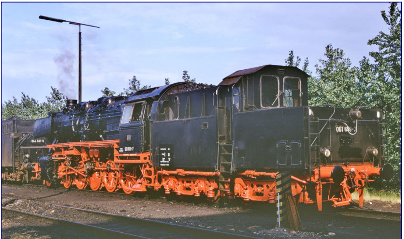
Der Blick auf den Kabinentender von 051 699-7 zeigt, wie die Märklin-Neuheit hinten auszusehen hat. Die Lok hat im AW Braunschweig eine Ausbesserung L0.2 erhalten und wartet am 19. Juni 1975 im nahen Betriebswerk auf die Rückfahrt nach Duisburg-Wedau. Foto: Dr. Uwe Knoblauch, Sammlung Eisenbahnstiftung
