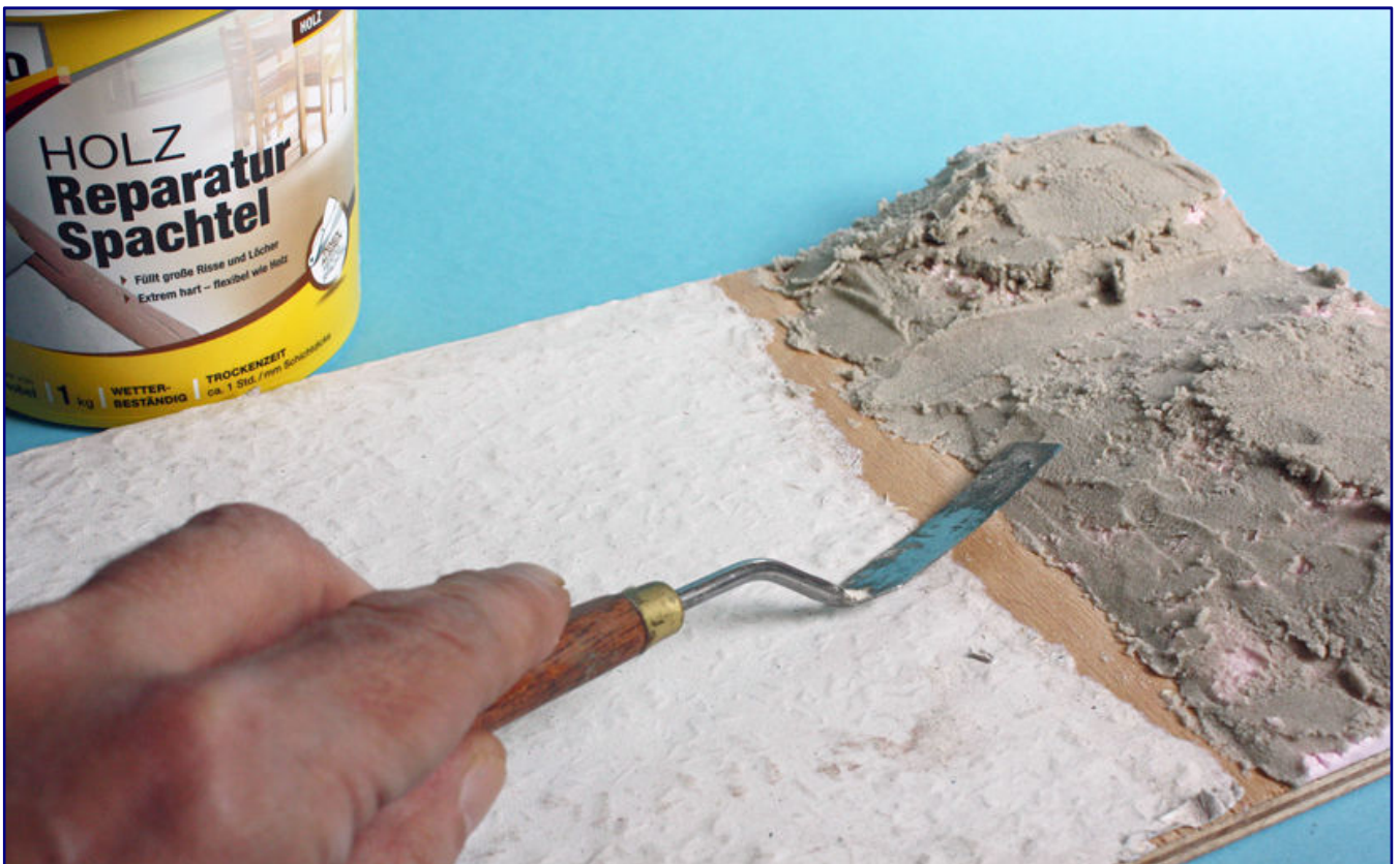
Mit scharfen Werkzeugen wird die Styrodur-Auflage in Form gebracht, bis sie keine glatten Flächen mehr hat (Bild oben). Dann folgt ein Überzug mit Holz-Reparaturspachtel (Bild unten).
