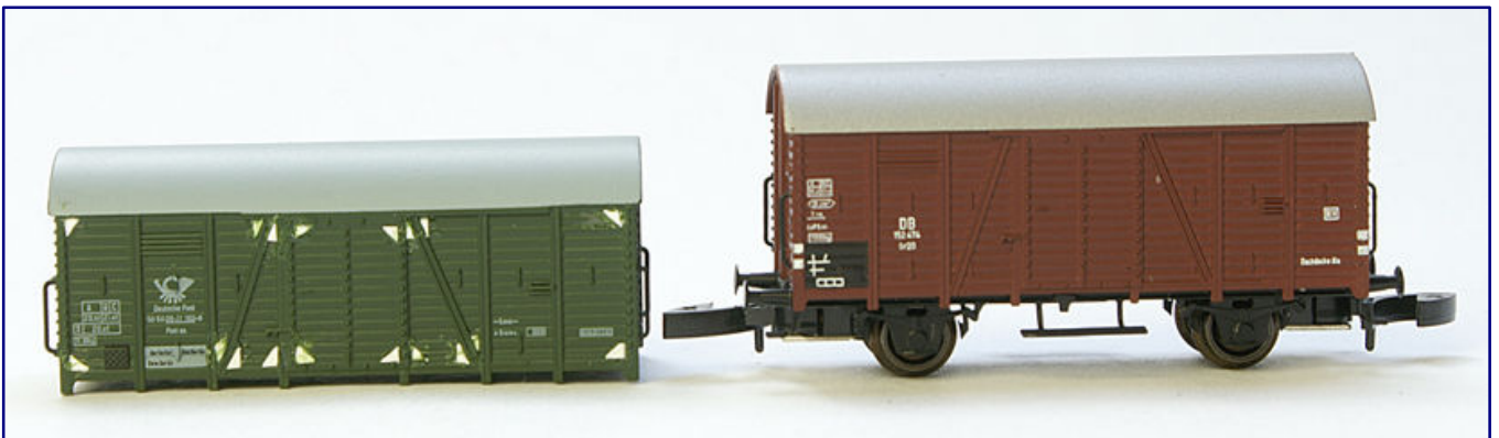
Die fehlenden Knotenbleche lassen sich aus unserer Sicht vernachlässigen, was wir mit dieser Vergleichsaufnahme belegen möchten: Am Gehäuse links haben wir sie mittels 0,13 mm dünnem Polystyrol maßstabsgerecht nachgebildet. Sie fallen nur im unlackierten Zustand mit maximalem Kontrast auf.
