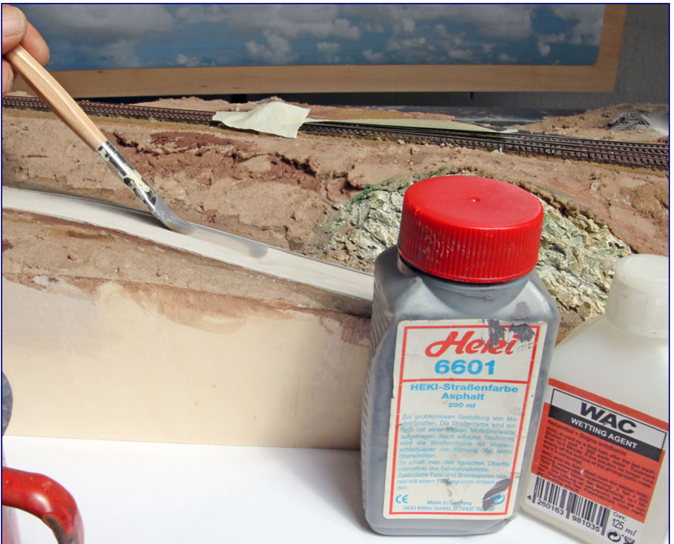
Ein wenig Wasser auf die Spitze des Spachtelmessers und im Anschluss kann der angetrocknete Reparaturspachtel glattgezogen werden (Bild oben). Der mehrmalige Lasurauftrag bewirkt eine mehr oder minder heruntergekommene Landstraße (Bild unten).
