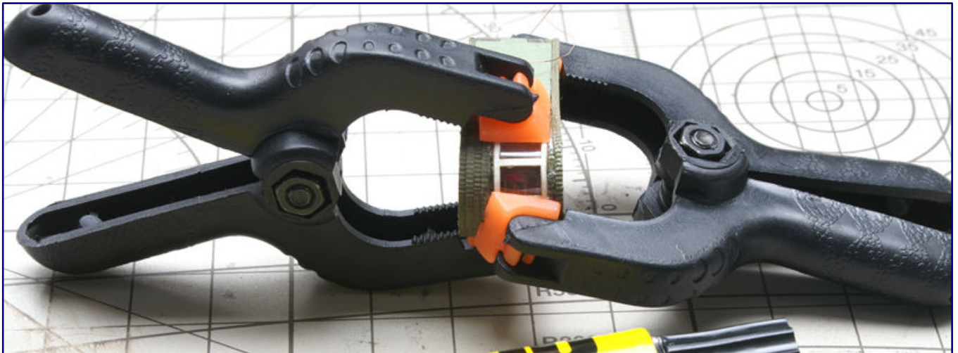
Die Revell-Spannzwingen erweisen sich als gutes Hilfsmittel, um das Fensterband nahtlos zu fixieren, während der Klebstoff trocknet.
