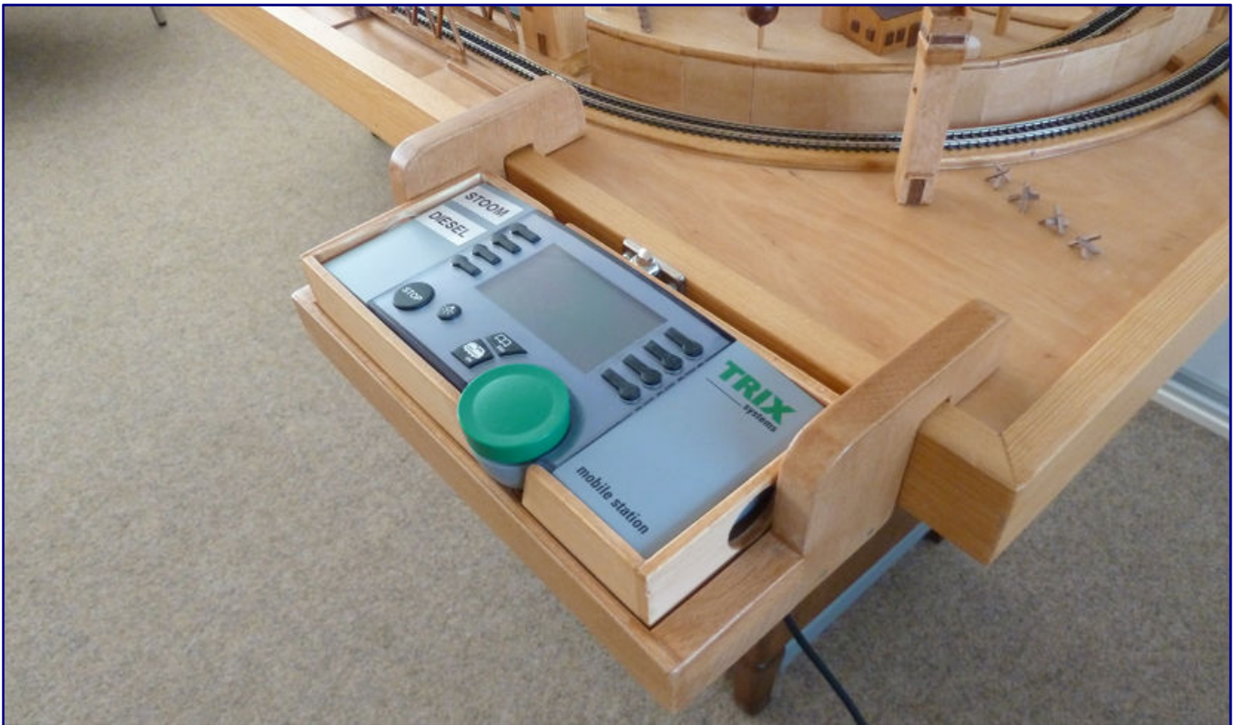
Der Betrieb lief von Anfang an digital nach dem Selectrix-Format. Bedient wird die Anlage heute über eine Trix-Mobile-Station 1, die in einem maßgefertigten und in die Anlage eingehängten Pult abgelegt wird.
