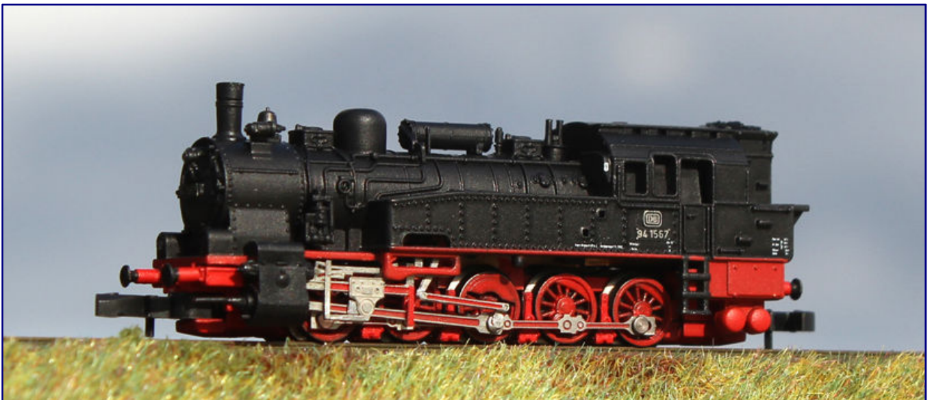
Dem gut laufenden Märklin-Modell der Baureihe 94 5-17 verhilft Bahls Modelleisenbahnen jetzt auch optisch in die 1. Klasse: Mit geätzten Schildern (hier als 94 1567), geradegerückten Dampfzylindern, größenrichtigen Puffern, Nachbildungen der Bremsen und eines vollständigen Gestänges bleibt kein Wunsch mehr offen. Auf Bestellung werden auch die funktionfähigen Laternen noch gegen feine Kleinserienteile getauscht. Foto: Michael Bahls
