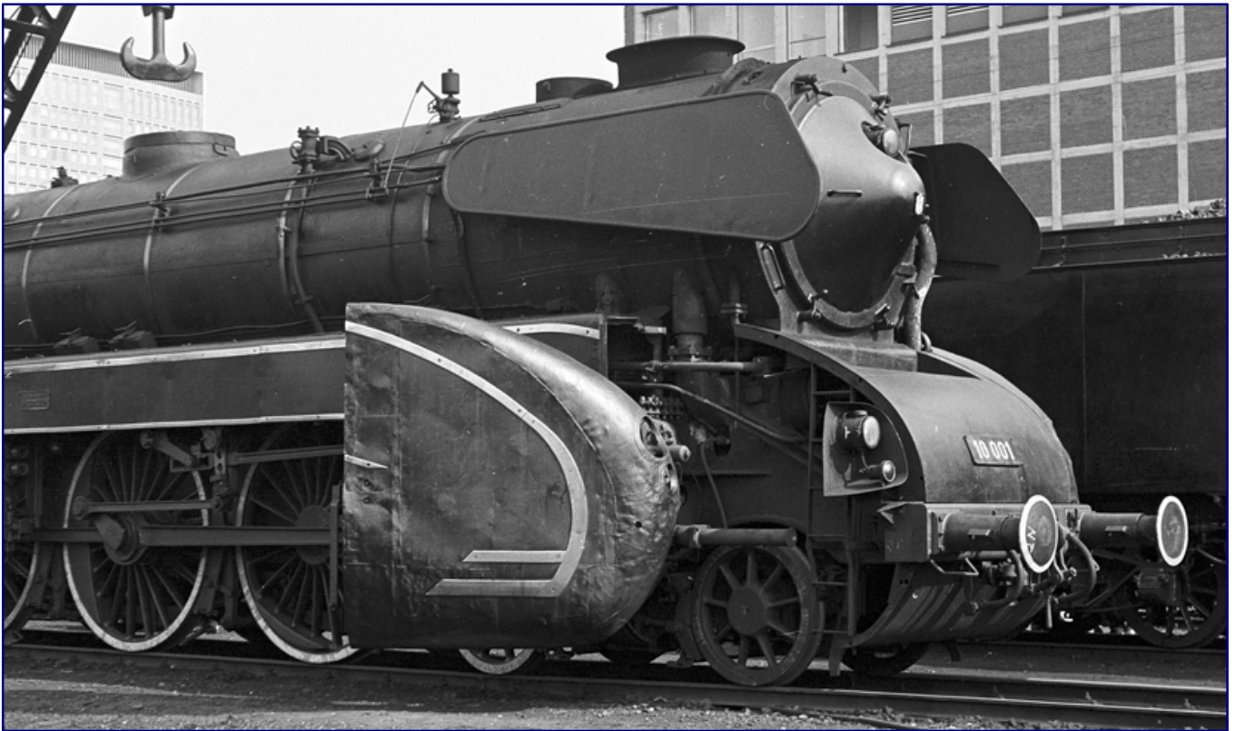
Die aufgeklappte Seitenschürze gibt den Blick auf einen Teil des vorderen Rahmens. Der darüber zu erkennende Innenzylinder bildet zusammen mit den Außenzylindern ein einheitliches Stahlgussstück, das mit dem Rahmen fest verschweißt ist (Mai 1967). Foto: Walter Patzke, Archiv Petkelis
