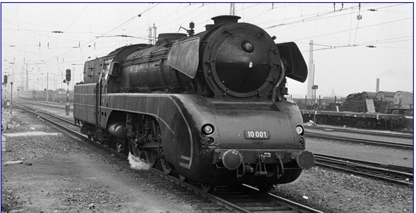
Im Mai 1965 zeigt sich 10 001 dem Fotografen bereits in ihrem letzten Bauzustand mit Einheitspfeife, Einfachventil-Dampfregler und Windstauschuten. Mit Ölhauptfeuerung ist sie ebenfalls schon seit vielen Jahren unterwegs. Foto: Walter Patzke, Archiv Petkelis
