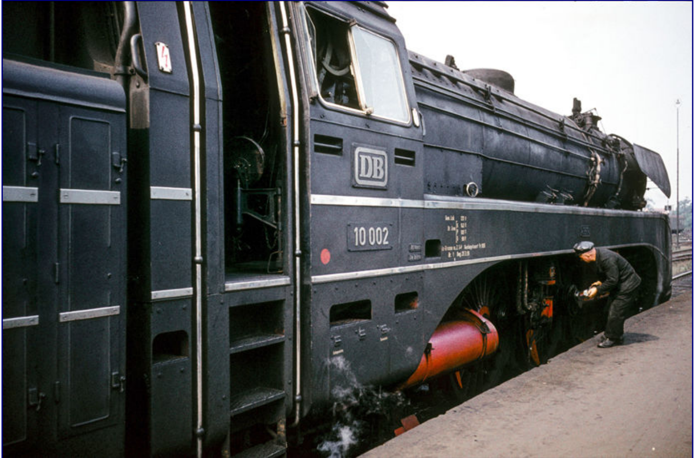
Beim Zwischenhalt in Hannover wirft der Lokführer von 10 002 des Bw Bebra einen prüfenden Blick aufs Triebwerk. Die offene Führerstandstür erlaubt einen Blick ins Innere mit dem in Fahrtrichtung zu bedienenden Reglerhebel. Foto:Archiv Petkelis (Fotograf unbekannt)
