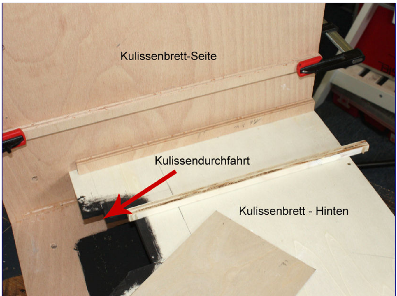
Der Kulissenkasten für das Segment „Blidsef“ (Anlage „Kniephaven“) ist fertig verleimt und vorbereitet für die „runde Ecke“.
