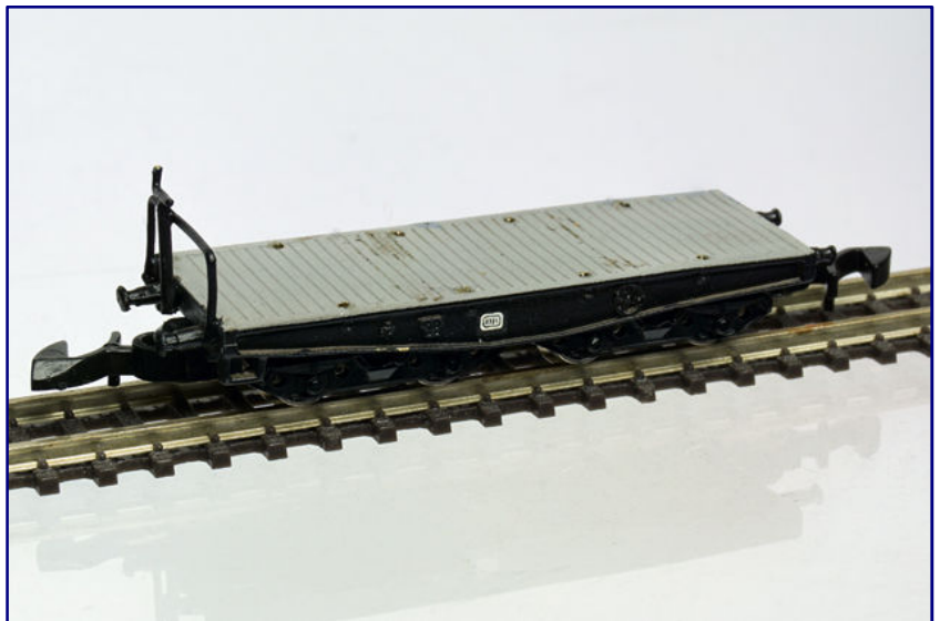
Ein damals zeitgemäßes Modell des Schwerlastwagens SSy 45 mit Trapezträger bot der Kleinserienhersteller Schmidt an. Es trug keine Betriebsanschriften, nur das DB-Logo war invers (Hell-/Dunkelflächen vertauscht) aufgedruckt. Mangels passender Drehgestelle lief dieser Wagen auf solchen der Bauart Minden-Dorstfeld von Märklin.
