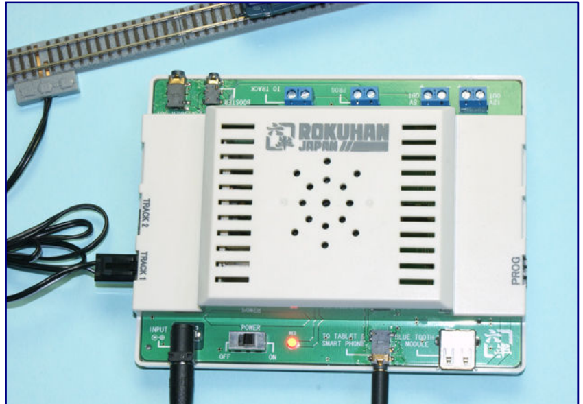
Auf der Bedienerseite liegen die Anschlüsse für den Bluetooth-Adapter bzw. das Bediengerät und die Stromversorgung. Auch der Ein-/Aus-Schalter und die Betriebsanzeige sind dort platziert. Die Rokuhan-Gleisanschlüsse befinden sich an den Seiten.
