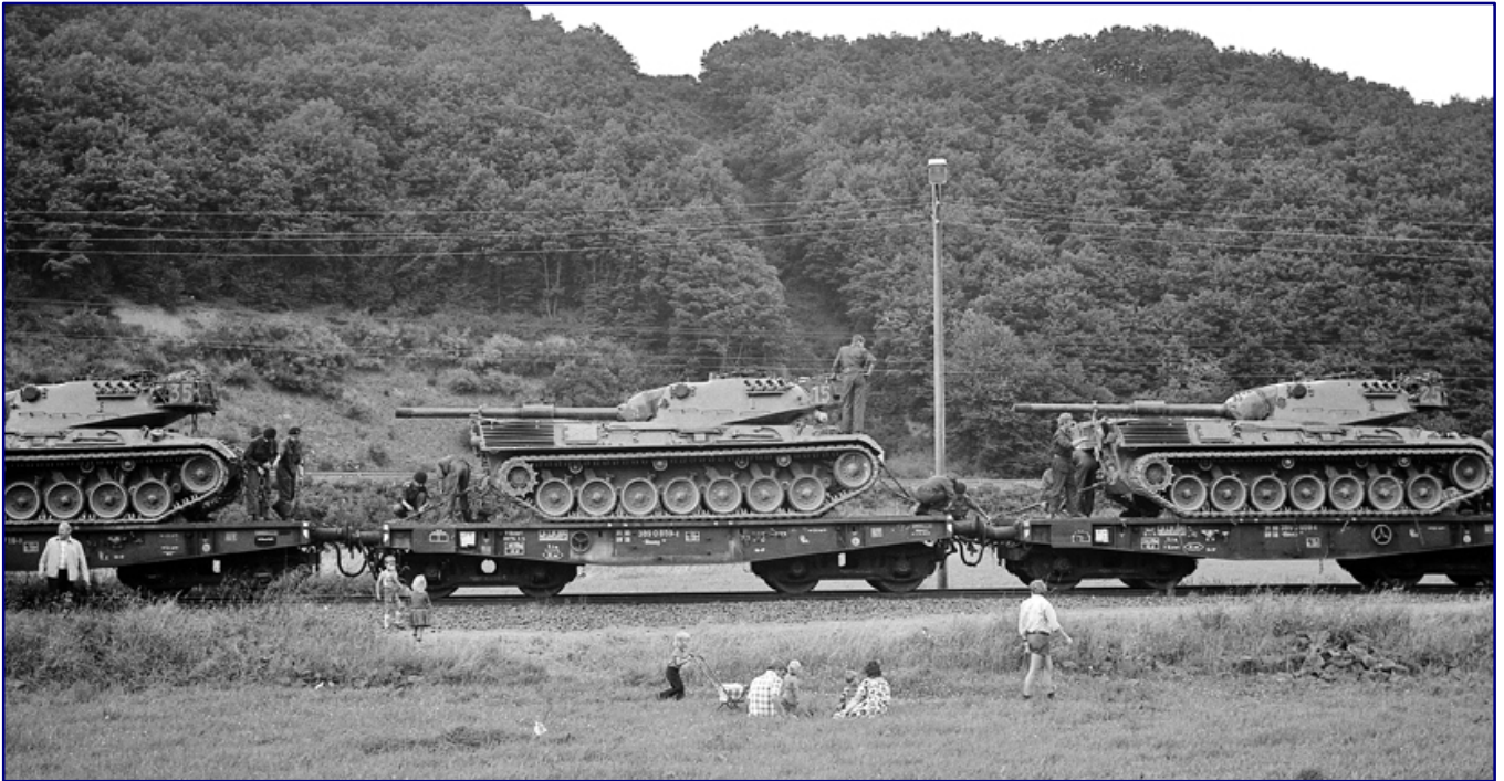
Unter den kritischen Augen der Dorfjugend findet die Panzerverladung auf Flachwagen der Bauart Rlmp 700 in Höddelbusch/Eifel statt. Mit über Kreuz gespannten Ketten werden die schweren Kettenfahrzeuge für den Transport gesichert. Foto: Joachim Bügel, Sammlung Eisenbahnstiftung
