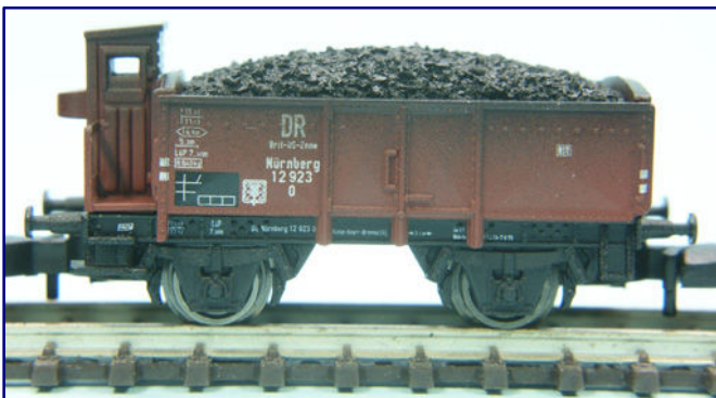
Vier Mal dieselbe Waggonbauart, drei unterschiedliche Anschriftenarten: umgezeichnete DB-Wagen der Bauart O 11 (Bild oben links und rechts), ein Wagen mit Bremserhaus, Reichsbahn-Betriebsnummer und Gattungsbezirk Nürnberg (Bild unten links) sowie ein zu „DR Brit-US-Zone“ rückgezeichneter Waggon (Bild unten rechts) mit Bauartbezeichnung und Waggennummer der DB.
