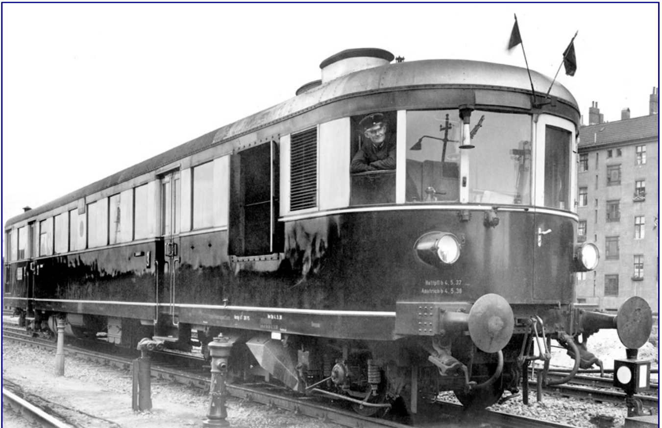
Beeinflusst durch die Erfolge mit vollautomatischen Dampferzeugungsanlagen, entstanden bei der Reichsbahn zwischen 1934 und 1938 acht Dampftriebwagen (DT 51 bis 58) von Borsig, Henschel und Wegmann. Hermann Maey lie  sich den neuen DT 53 in Berlin Stettiner Bahnhof am 4. Mai 1936 in Position fahren. Foto: DLA Darmstadt (Hermann Maey), Sammlung Eisenbahnstiftung
