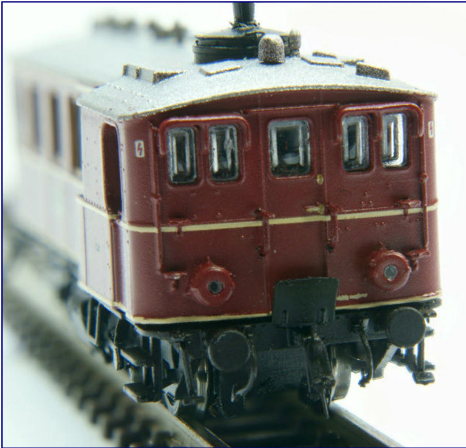
Der Blick auf die Front offenbart gleich die filigransten Teile des Dampftriebwagens: Tritte rechts und links der Puffer, Schraubenkupplung und Bremsschläuche. Auch die Geländer neben der Stirntür sind freistehend nachgebildet worden.
