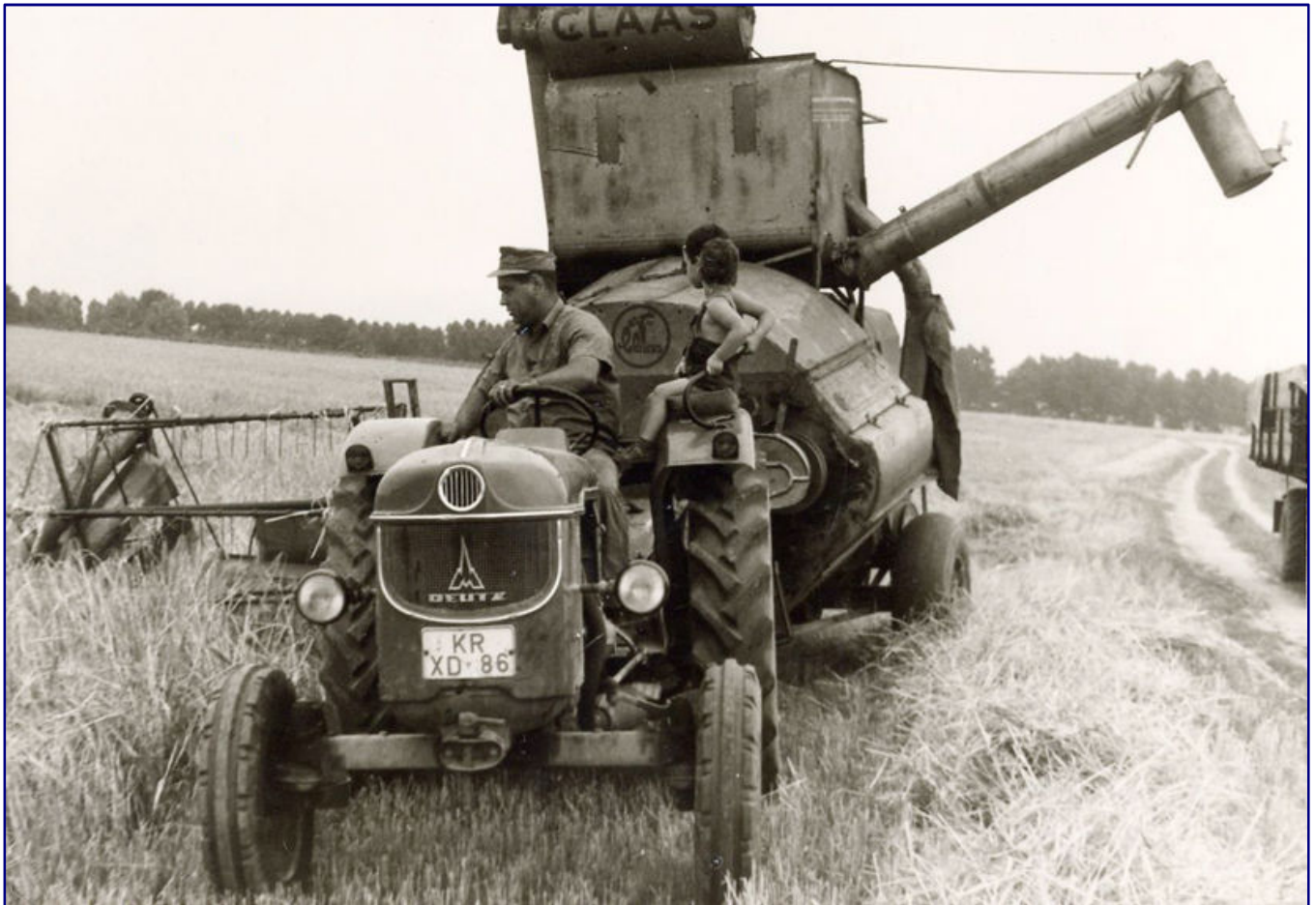
Die Entwicklung eines Mähdreschers nahm in Deutschland zuerst der Hersteller Claas auf. 1946 erlangte die Maschine Serienreife. Das Ergebnis in Form des gezogenen Mähdreschers Claas Super ist hier in einer späteren Ausführung mit Korntank im Jahre 1969 bei der Ernte hinter einem Traktor Deutz D40 zu sehen. Foto: Mgweb (gemeinfrei)
