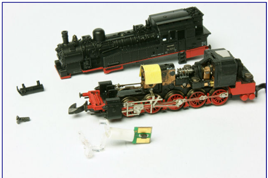
Mit dem LED-Einsatz der Baureihe 01 lässt sich die fahrtrichtungsabhängige Stirnbeleuchtung aufwerten. Wir haben gleich noch den weißen Schrumpfschlauch der früheren Glühlampe über Leuchtdiode und Klarsichteinsatz gezogen.
