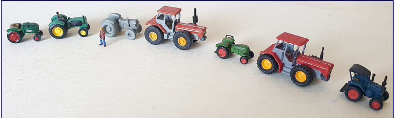
Chronologie einer Evolution (v.l.n.r.): geschnitzter Trecker aus der Frühzeit, ein MAN mit Laserschnittchassis, ein Prototyp mit Laserschnittchassis, Schlüter-Schlepper aus dem FDM-Verfahren (10 Teile) sowie aus dem SLA-Druckverfahren ein Deutz D25, Schlüter TVL2000 und Lanz. Foto: Michael Hering
