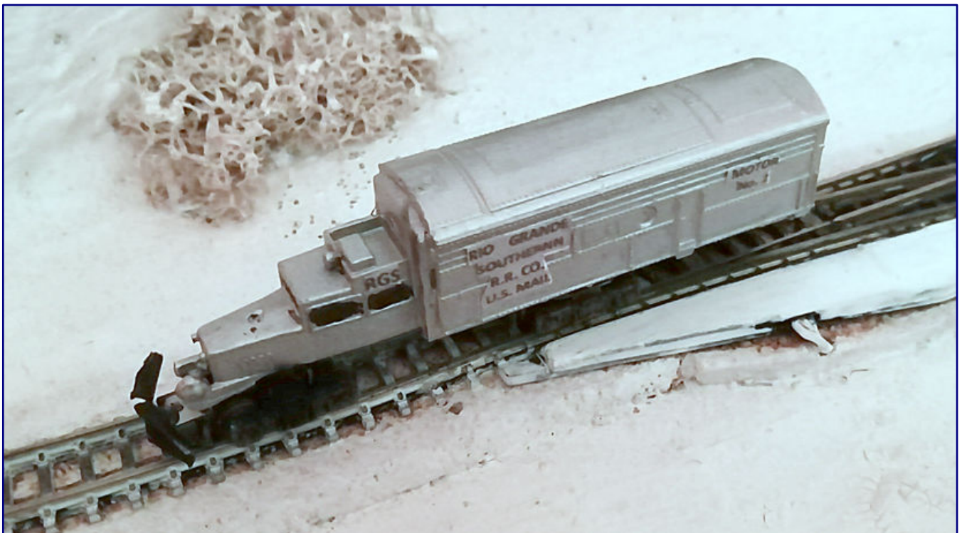
Der Blick aufs Dach des fertigen Modells zeigt, dass die Lüfterrotoren der EMD F7 verschwunden sind: abgeschabt, geschliffen, gespachtelt und lackiert. Foto: Markus Krell
