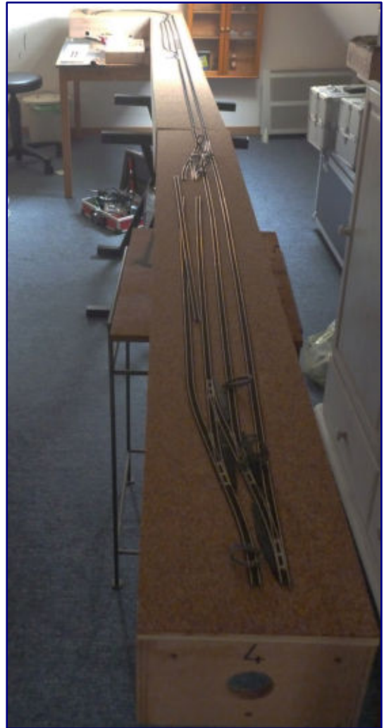
Auf den fertigen Kästen ist eine 3-mm-Korkschiicht verlegt. Im Anschluss erfolgt der Probeaufbau von Gleisen, um den Plan besser beurteilen zu können.
