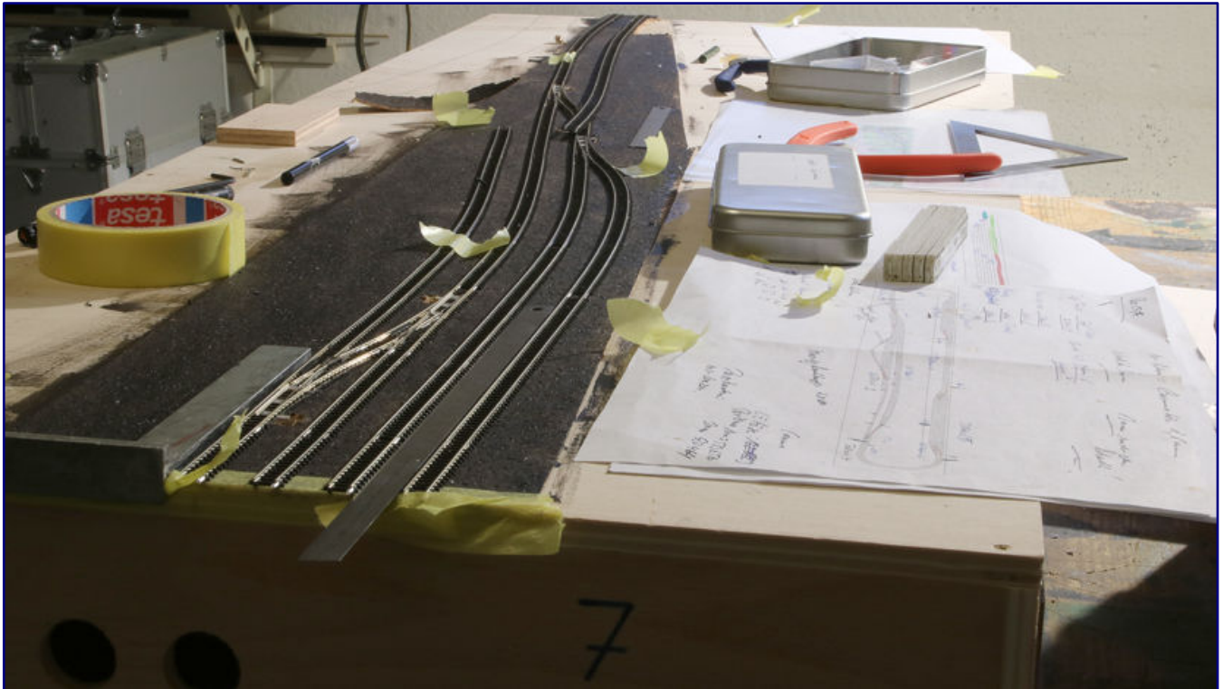
Die Weichen sind ihrer seitlichen Kästen beraubt und, für einen Unterflurantrieb vorbereitet, montiert. Penibel wird auf den korrekten Gleisabstand geachtet, der mit einem Lineal „abgesteckt“ ist.
