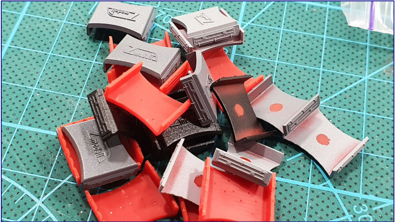
Die abgefrästen Mittelteile des Ellok-Gussblocks wurden mit im SLA-Verfahren gedruckten Teilen abgedeckt, die den zwischen den Achsen angesetzten Kraftstofftank der Diesellok nachbilden.
