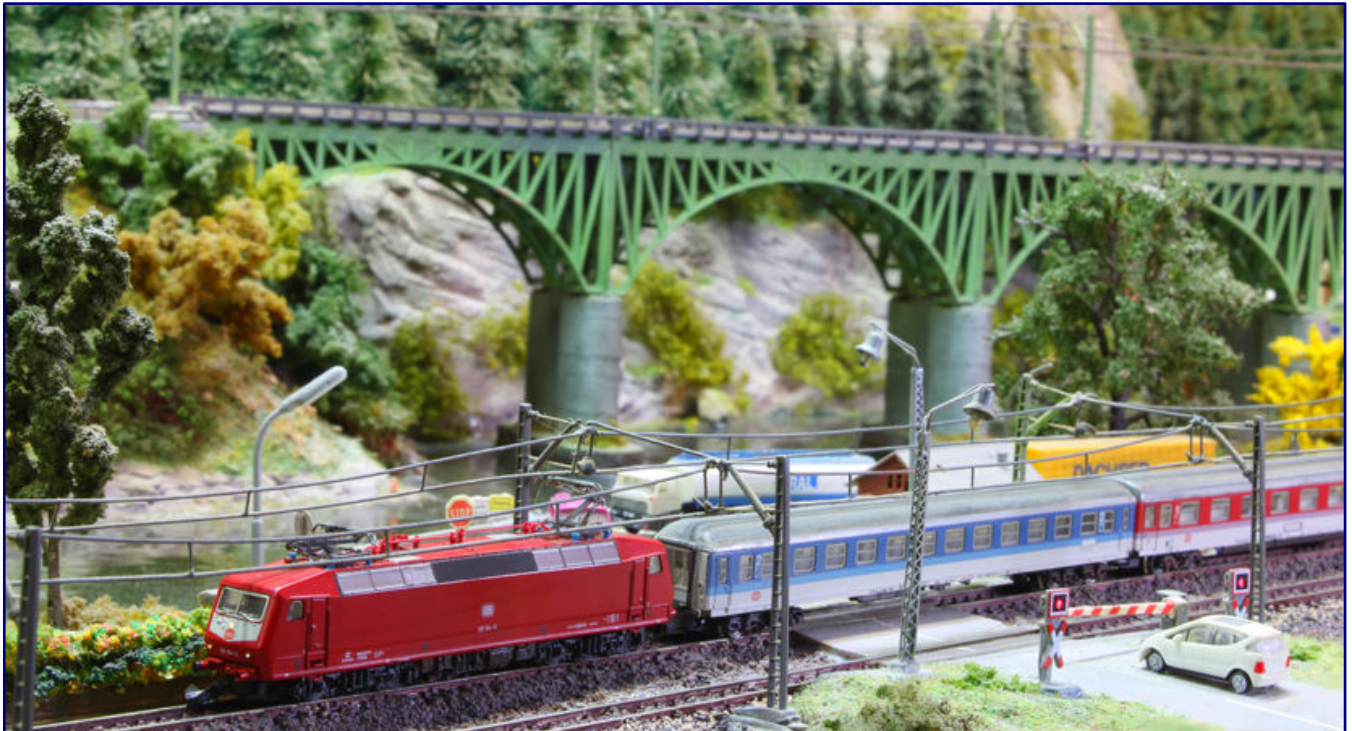
Die Baureihe 120 durchfährt mit einem Interregio den Halbschranken-Bahnübergang von Märklin, der einen Lemaco-Motorenantrieb erhielt, damit sich die Schrankenbäume vorbildgerecht heben und senken.
