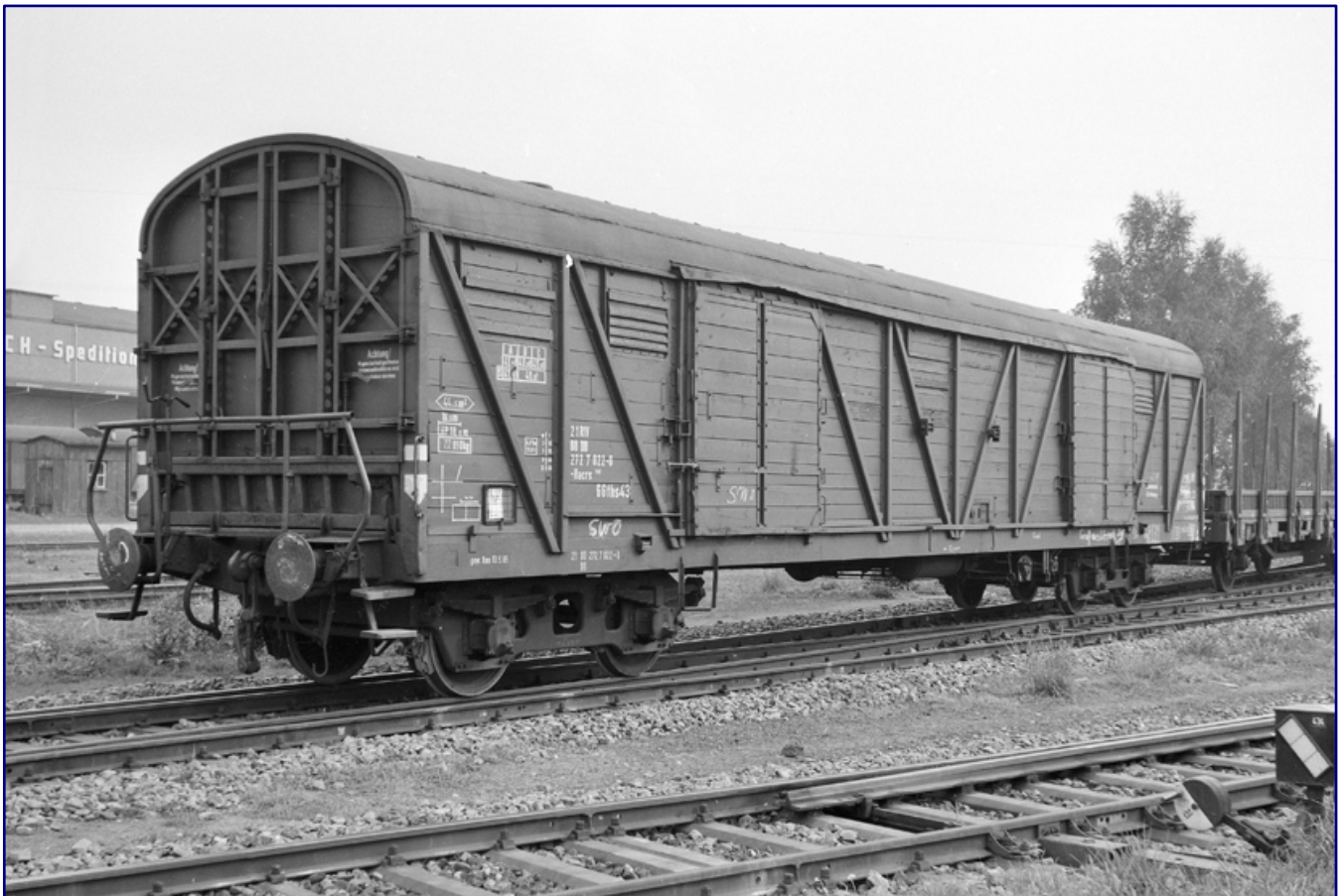
Im Bahnhof Offenburg offenbart der Hacs 340 (ex GGths 43) mit der Betriebsnummer 21 80 272 7 022-0 im Mai 1967, dass er aus den frühen Lieferungen seiner Bauart stammt: Seine vierflügeligen Stirnwandtüren sind im oberen Bereich kreuzweise versteift. Foto: Reinhard Todt, Eisenbahnstiftung
