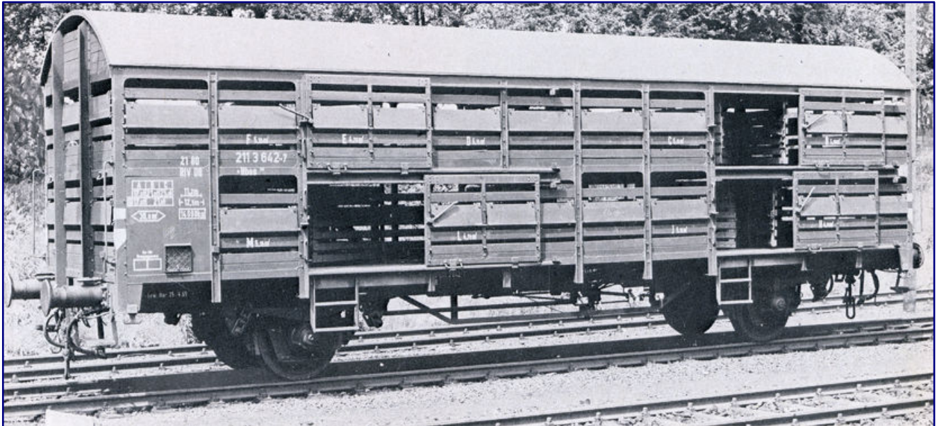
Ab 1968 wurden die verbliebenen und nicht zu gedeckten Wagen der Regelbauart umgebauten Verschlagwagen als Hbes 358 bezeichnet. Auf dem Bild gut zu sehen sind die Drehtüren zum Trennen der einzelnen Verschläge. Foto: Werbeamt der Deutschen Bundesbahn, Slg. Trainini
