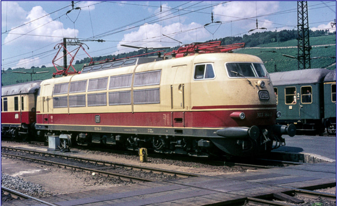
Was immer sich im IC-Konzept auch ändern sollte, die Baureihe 103 blieb dreißig Jahre lang die Stütze dieses Systems. Als 103 164-0 in Würzburg Hbf aufgenommen wurde, trug sie noch ihre Frontschürze und auch die Scherenstromabnehmer DBS 54 mit Wanisch-Wippe. Foto: Archiv Petkelis
