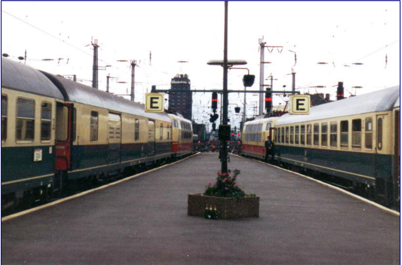
Diese Aufnahme aus Köln Hbf, aufgenommen 1980, verdeutlicht das Prinzip der zeitgleich am selben Bahnsteig haltenden Züge zum schnellen Umsteigen. Die neu eingeführten Bahnsteigabschnitte, im Bild zu sehen die Schilder mit der Kennzeichnung E, gehören auch zum IC '79. Der links haltende IC 625 „Meistersinger“ führt als einer der wenigen Intercity einen Gepäckwagen mit. Foto: KlausMiniwolf (CC-BY-SA-4.0)
