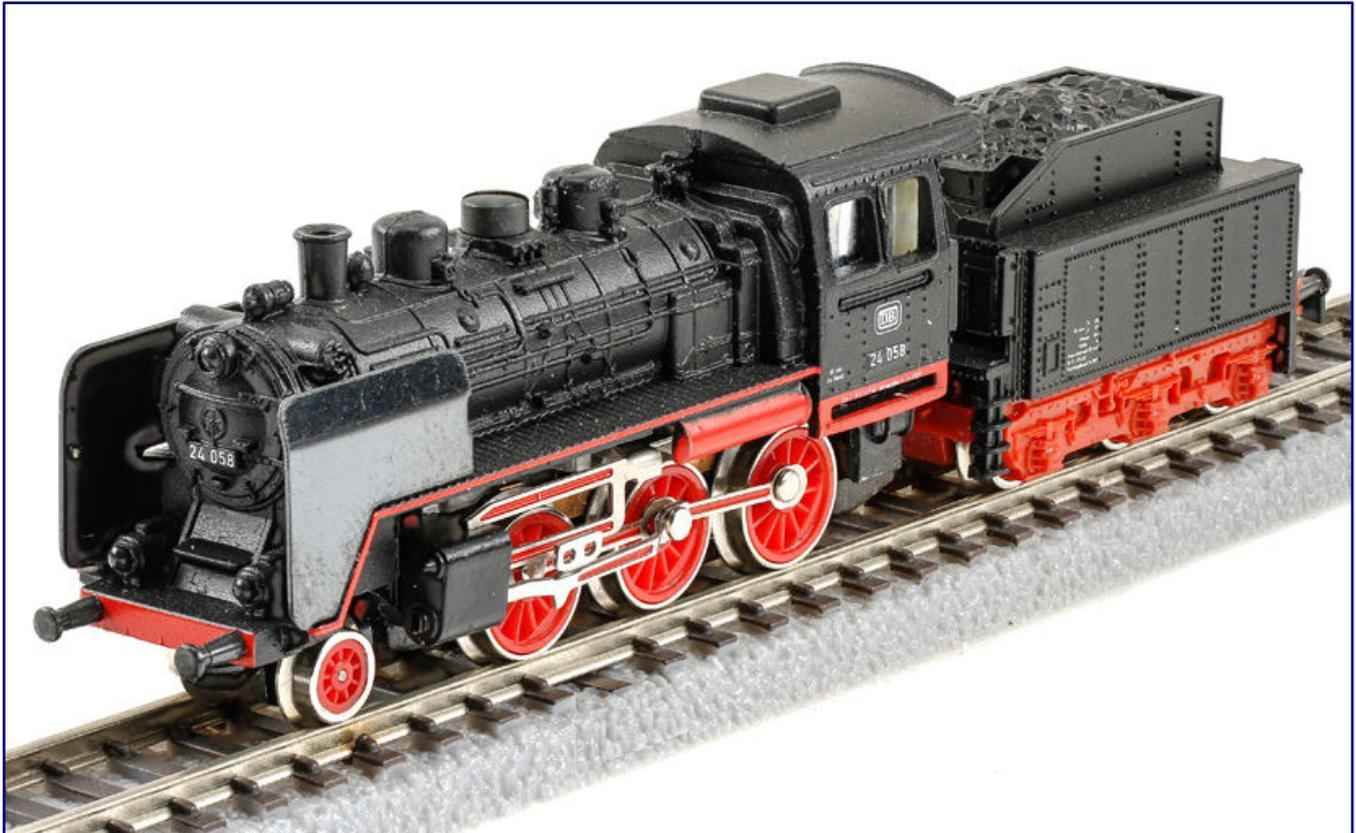
Viele der frühen Konstruktionen waren herunterskalierte Modelle der Baugröße H0. Verraten haben dies vorbildwidrige Merkmale wie die „Stehkesselbeule“ an der Baureihe 24 (8803) vor dem Führerhaus, die erst nach Jahrzehnten mit einer Produktpflege verschwand. Foto: Peter Fingerhut (1zu220-Shop)
