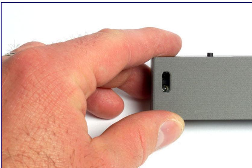
In den zuvor genannten, im Gehäuse recht hoch platzierten Öffnungen lassen sich die Sender- und Empfängerdiode der Lichtschranken erkennen.
