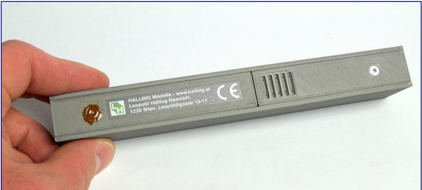
Das Gehäuse stammt unverkennbar aus dem 3D-Drucker. An seiner Unterseite finden wir ein verschraubtes Batteriefach (rechts). Hier wird eine 9-Volt-Blockbatterie eingelegt. Alternativ funktioniert das Messgerät auch mit einem Akku, der aber nicht im Gerät geladen werden kann.
