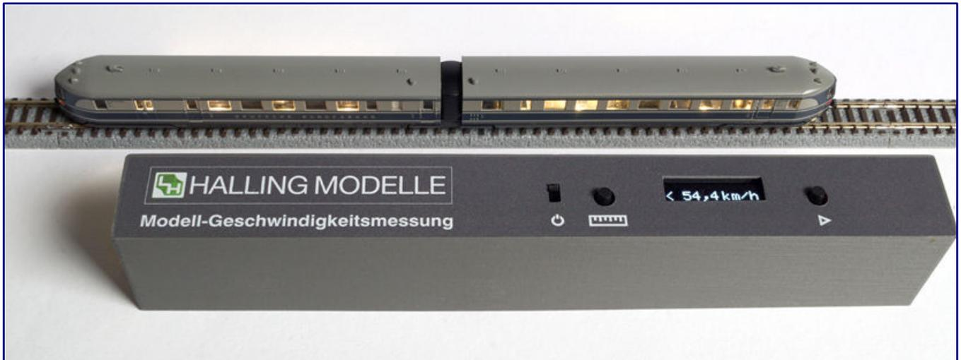
Mit gezielt gewählter Fahrstufe und im Decoder hinterlegter Geschwindigkeit wird der Messabschnitt durchfahren, um den Ist-Wert zu ermitteln.
