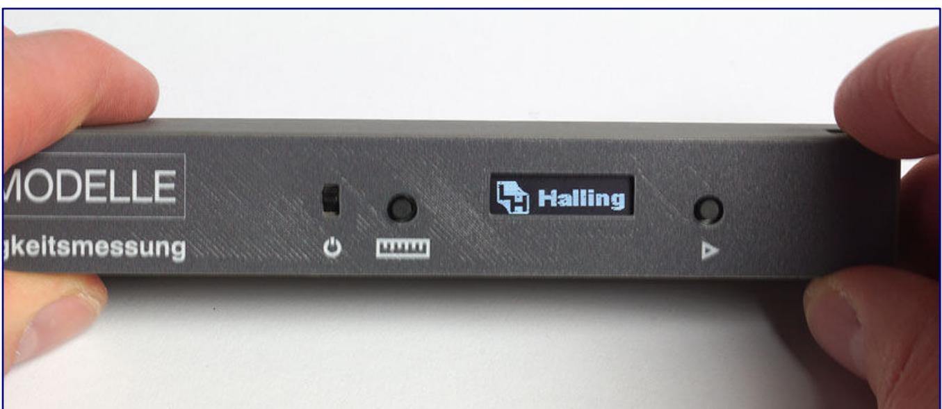
Nach dem Bedienen des Ein-Aus-Schiebeschalters mit international standardisiertem Symbol erscheint zunächst für 1 Sekunde das Halling-Logo auf der beleuchteten Geräteanzeige.
