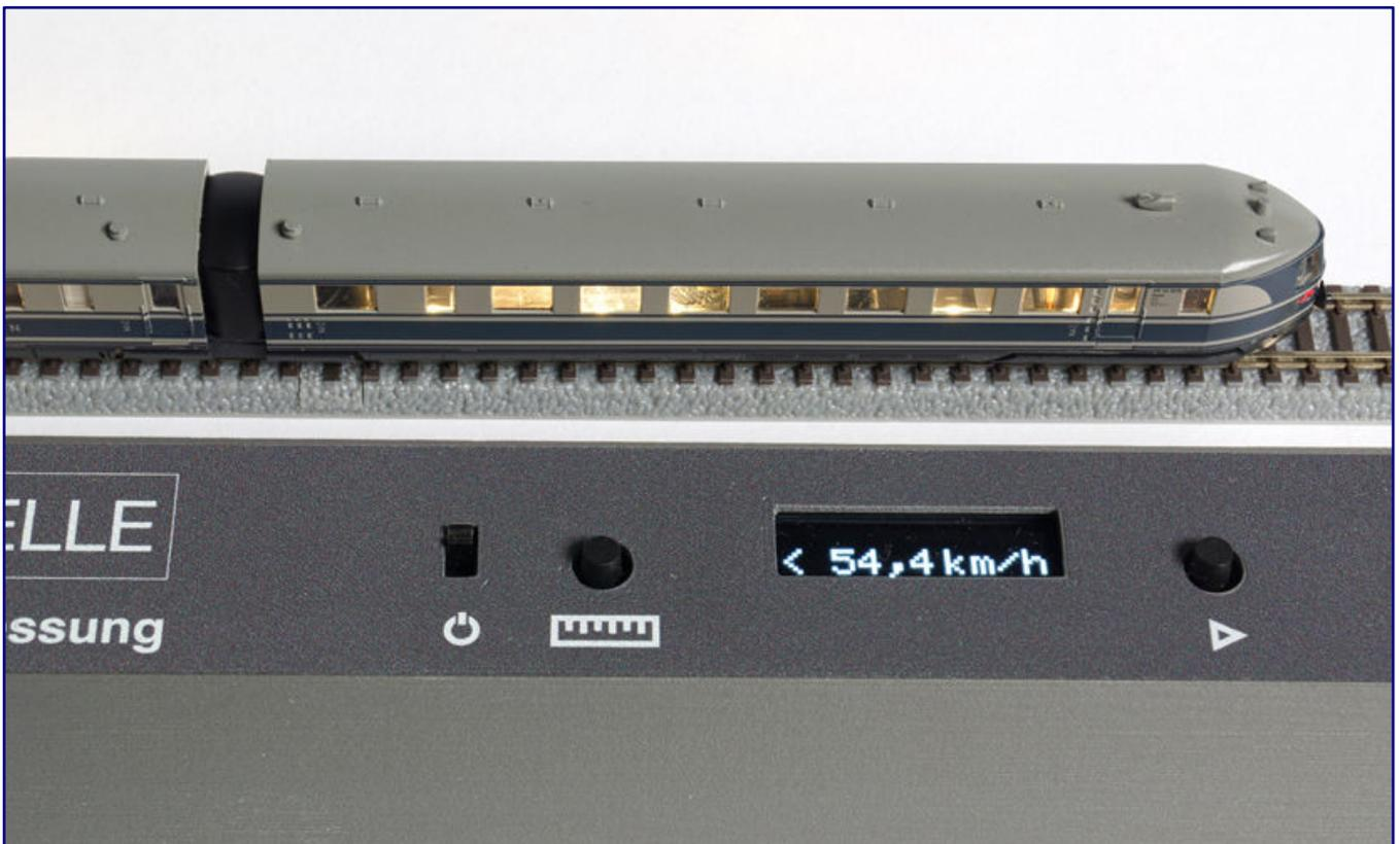
Anschließend lässt sich der vom MTS-100 ermittelte Wert mit dem Soll-Wert der Decodereinstellung abgleichen und im Bedarfsfall anpassen. Dies wird dann so oft wiederholt, bis die Ergebnisse zusammenpassen.
