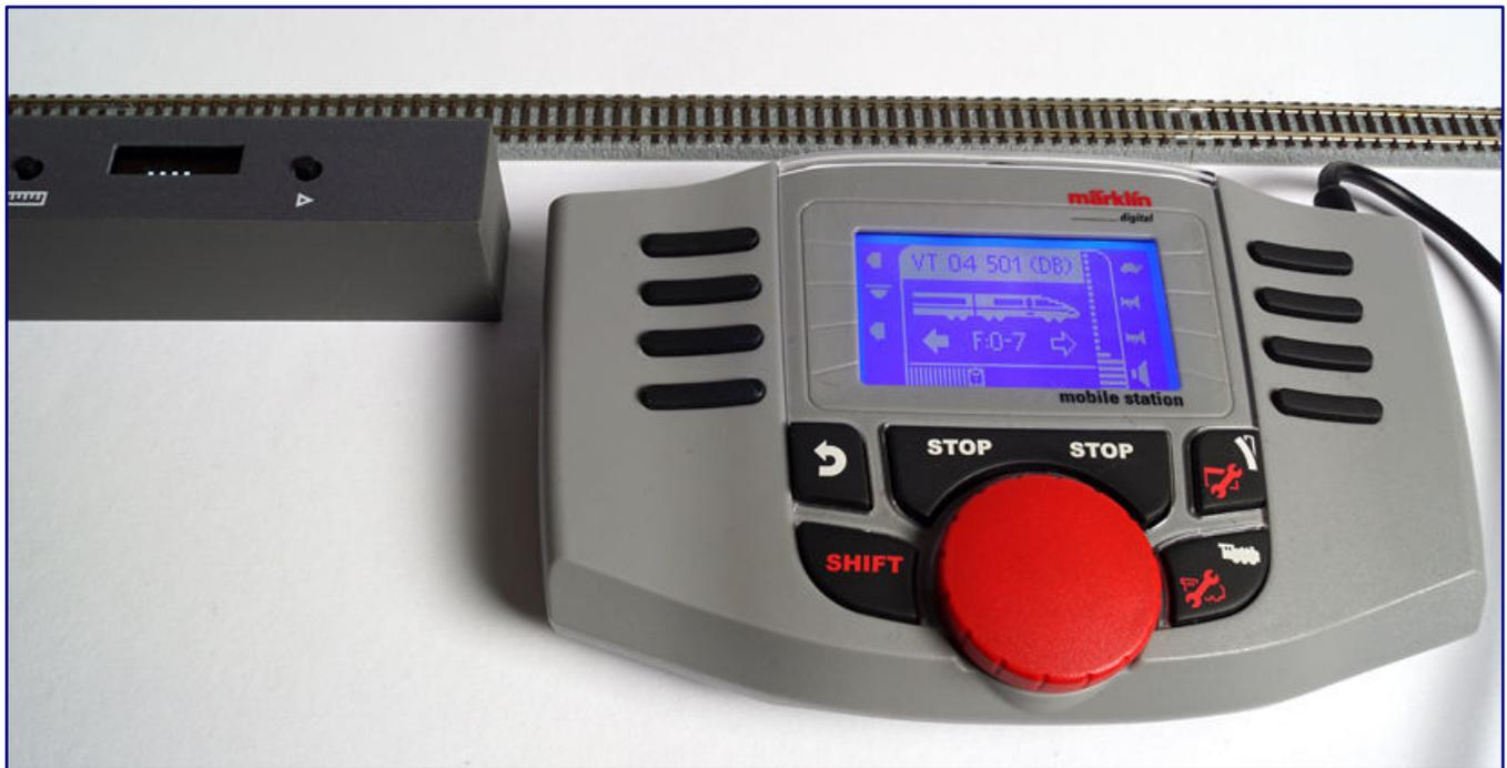
**Nützlich wird der Modell-Geschwindigkeitsmesser auch im Digital-Betrieb: Wenn Geschwindigkeitseinstellungen in den CV-Registern hinterlegt werden, hilft der MTS-100 beim Abgleich der programmierten Soll-Werte und den tatsächlich gefahrenen Geschwindigkeiten.**
