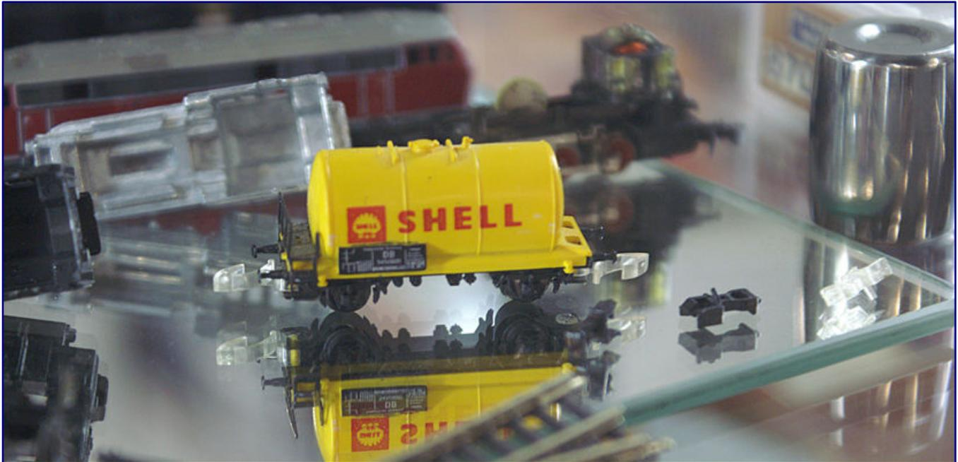
Eine Experimente auf dem Wege zur endgültigen Systemkupplung sind hier zu sehen: Bis auf den nach unten zeigenden Zapfen für das Eingreifen des Entkopplungsgleises, der hier noch fehlt, entspricht der transparent gespritzte Haken am Kesselwagen der ersten Serienausführung. Verworfen wurde hingegen die schwarze Ausführung, die der damals ebenfalls noch jungen, „neuen“ Spur 1 folgte. Im Hintergrund ist mit der Baureihe 216 (Art.-Nr. 8875) übrigens eine weitere Lok des Startsortiments zu sehen.
