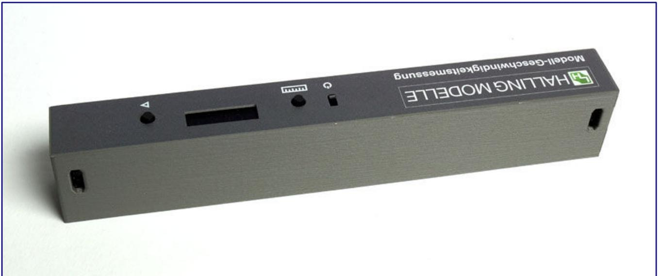
Auf der vom Bediener abgewandten Längsseite finden wir zwei rechteckige Öffnungen mit ausgerundeten Ecken: Hier sind die Lichtschranken verbaut, von denen der durchfahrende Zug erfasst werden soll.
