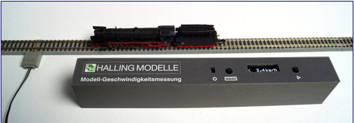
Das zuletzt von uns getestete Lokmodell war Märklins Baureihe 41 Öl. Die mit dieser Dampflok manuell ermittelten Geschwindigkeitswerte lassen sich bei gleicher Fahrspannung mit dem MTS-100 verifizieren.
