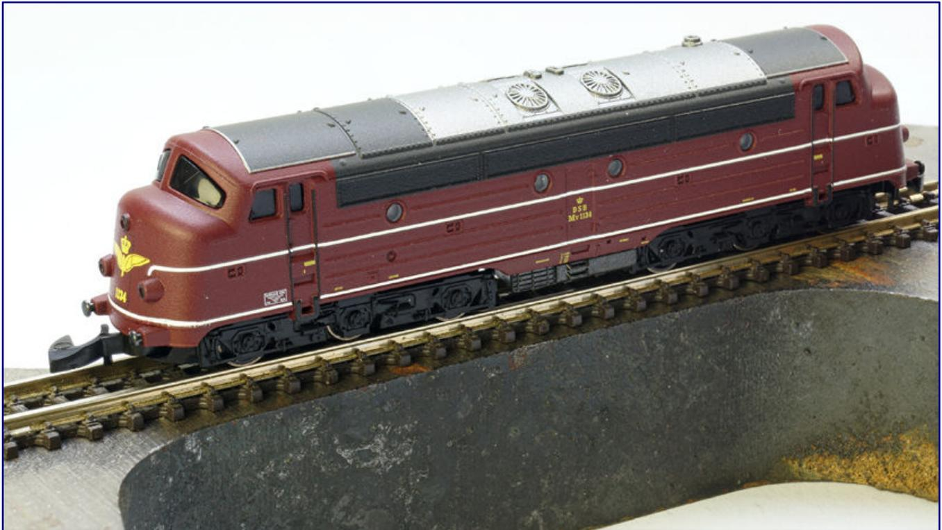
Eine antriebslose Mittelachse besitzen die jüngeren Auflagen der NOHAB-Diesellokomotiven, erkennbar schon an den neuen und vorbildnäheren Drehgestellblenden (hier 88367). Der metallgefüllte Kunststoff ihres Gehäuses für mehr Masse und Zugkraft ist eine weitere Innovation, die der Spurweite Z guttut.
