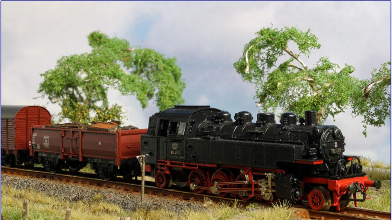
**Bahls Modelleisenbahnen war es vergönnt, ab 2012 eine vollbewegliche Detailsteuerung zuvor unbekannt maßstäblicher Ausführung anbieten zu können. Vorgeführt wird sie hier an 86 457, deren Basismodell 8896 im Hause Märklin das erste war, das eine rot hinterlegte statt der vollständig blanken Steuerung erhielt.**
