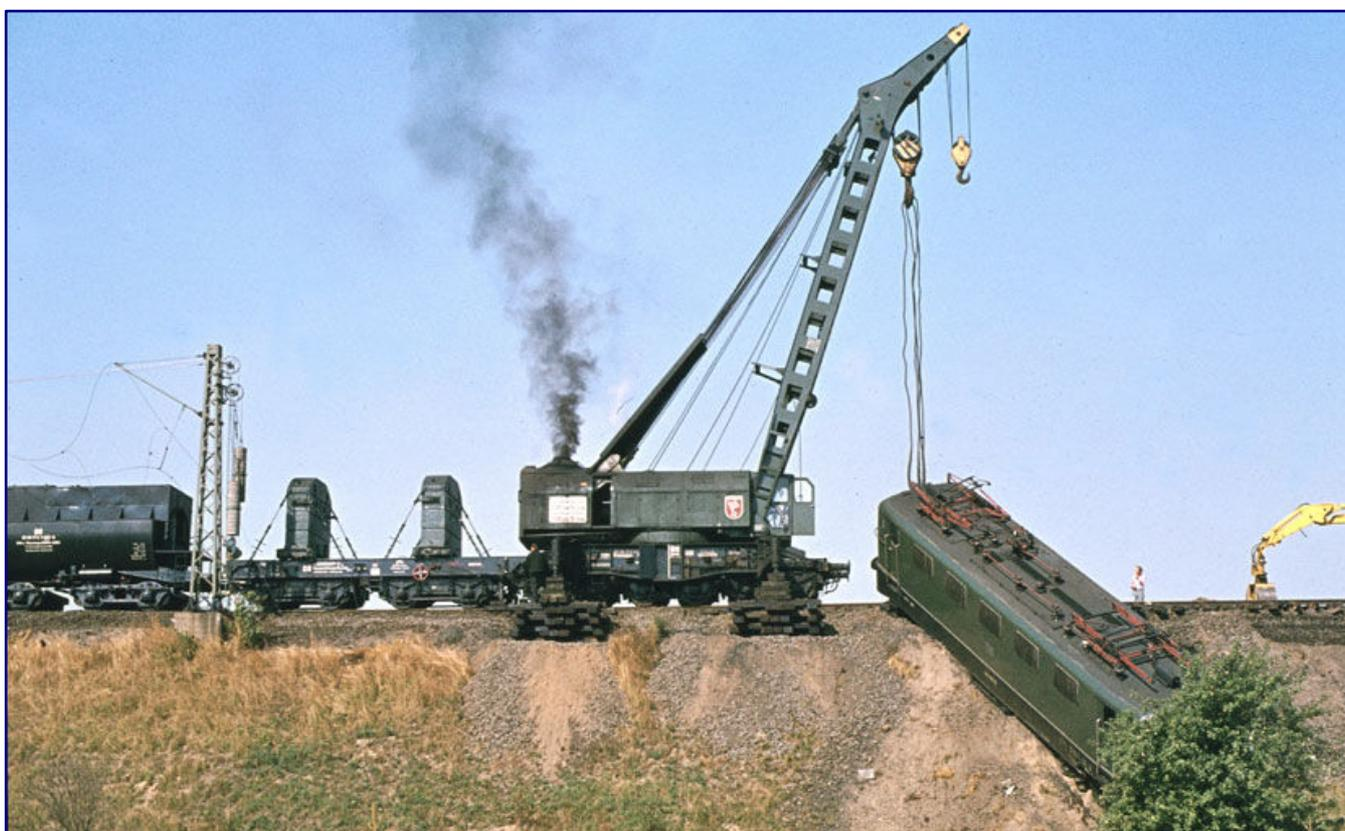
Bild oben: Der 57-Tonnen-Dampfkran „Mainz 6600“ (Ardelt, Baujahr 1949) wird 1955 in Frankfurt (Main) für einen Brückeneinsatz angeheizt, bei dem ein leichterer Kran mit im Einsatz ist. Foto: Reinhold Palm, Slg. Eisenbahnstiftung
