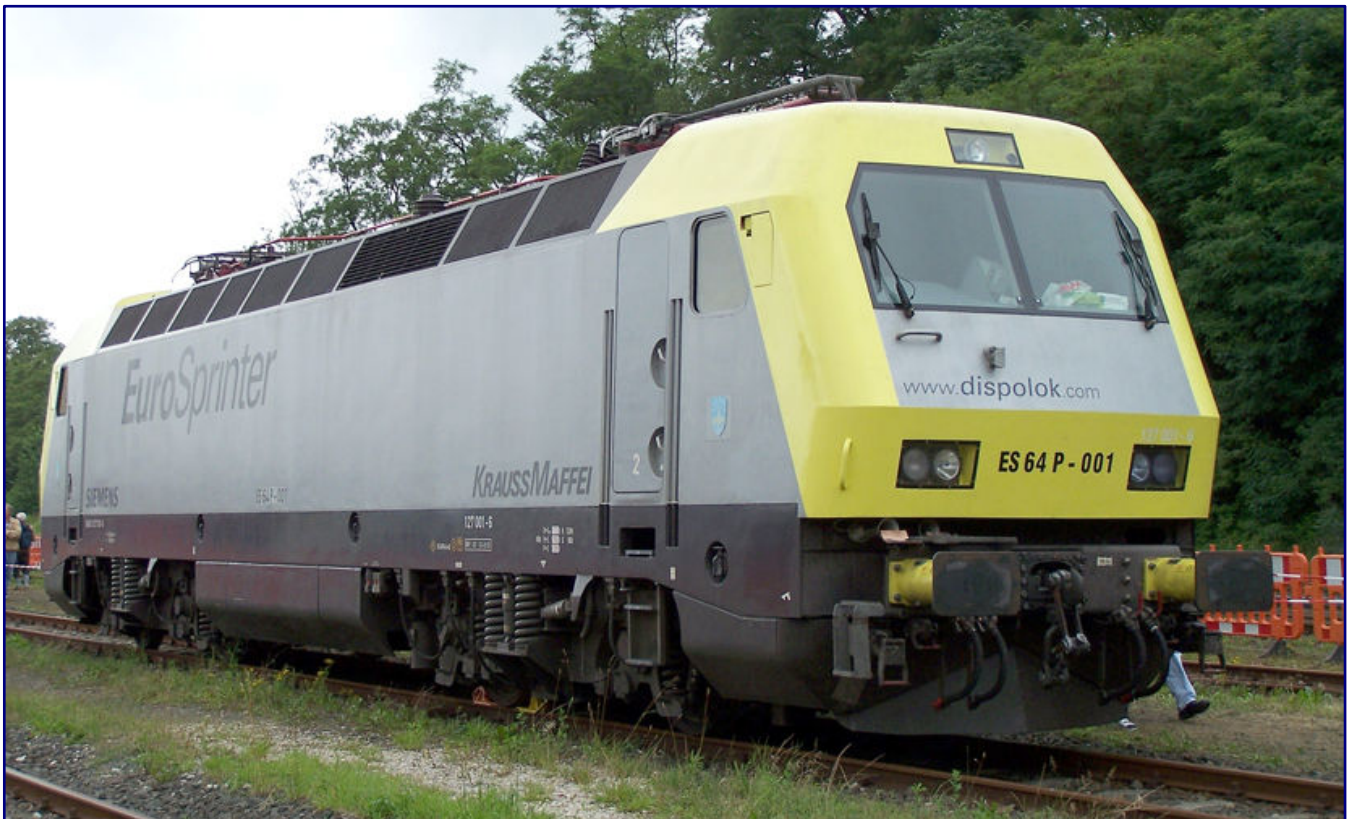
Siemens schickte 127 001-6, den „EuroSprinter“, ins Rennen um eine moderne Drehstromlokomotive in Nachfolge der Baureihe 120. Die intern als ES 64 P bezeichnete Lok wurde zum Urvater der Siemens-Lokomotiven bis zur Vectron-Plattform. Foto: Urmelbeauftragter (CC-BY-SA-3.0,2.5,2.0,1.0)
